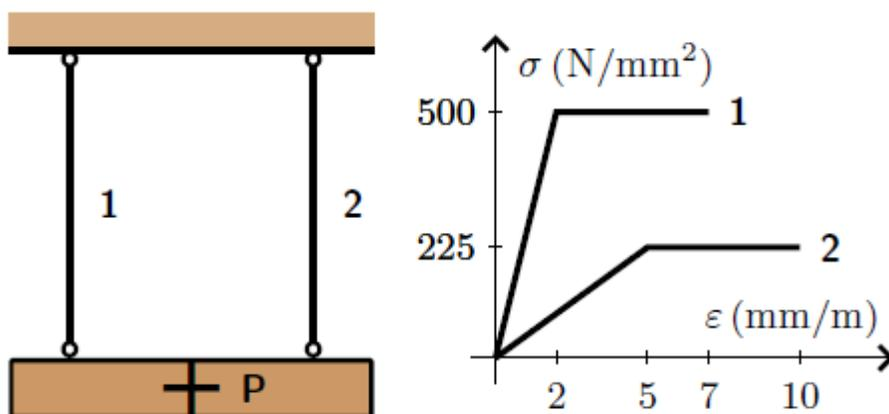
Se supondrá que la coordenada horizontal del centro de gravedad está equidistante de los dos cables. Los diagramas esfuerzo-deformación informan que los materiales de los cables tiene un comportamiento elasto-plástico. En este caso el cable del material 1 está limitado a un esfuerzo máximo de  $500 \text{ N/mm}^2$  y el cable 2 a  $225 \text{ N/mm}^2$ .
