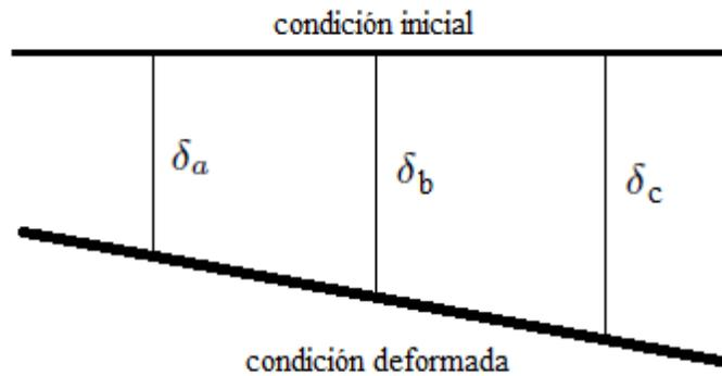
Por triángulos semejantes se obtiene la ecuación de compatibilidad
