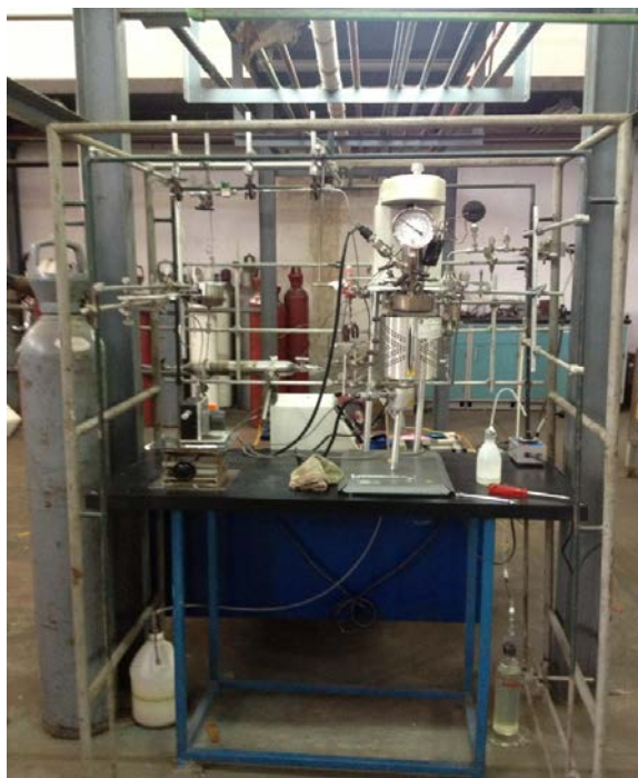
Figura N° 15. Sistema de reacción empleado para la HDS de tiofeno
