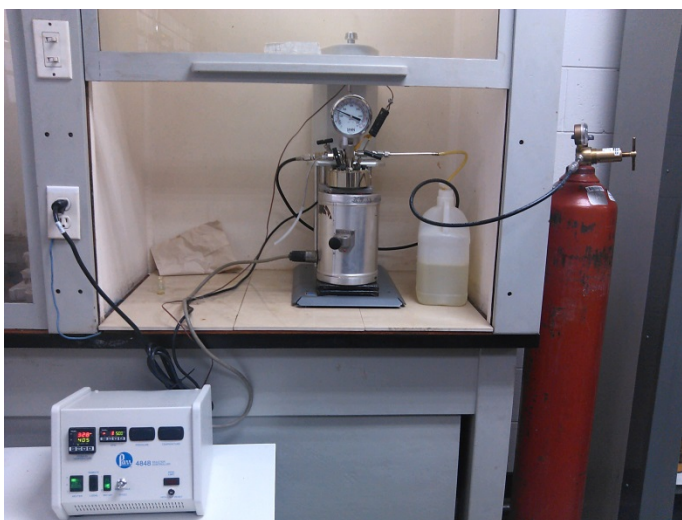
Figura N° 16. Sistema de reacción empleado para ensayos catalíticos con VGO
