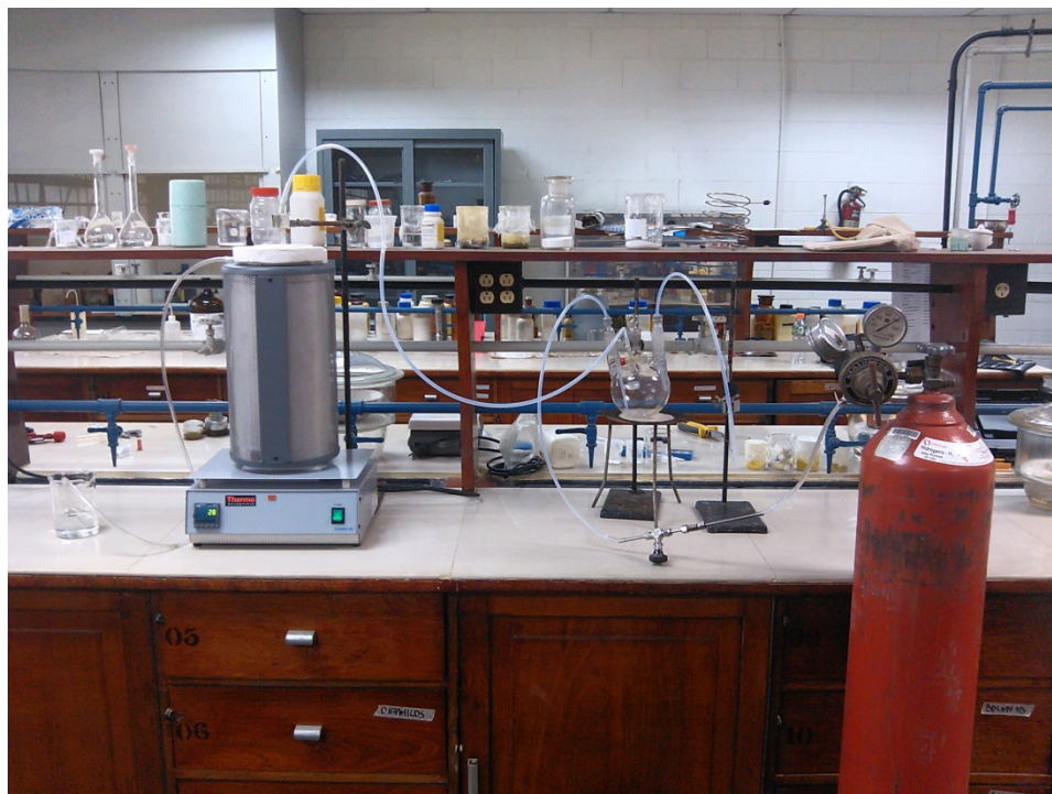
Figura N° 12. Montaje del sistema de síntesis de sólidos catalíticos
