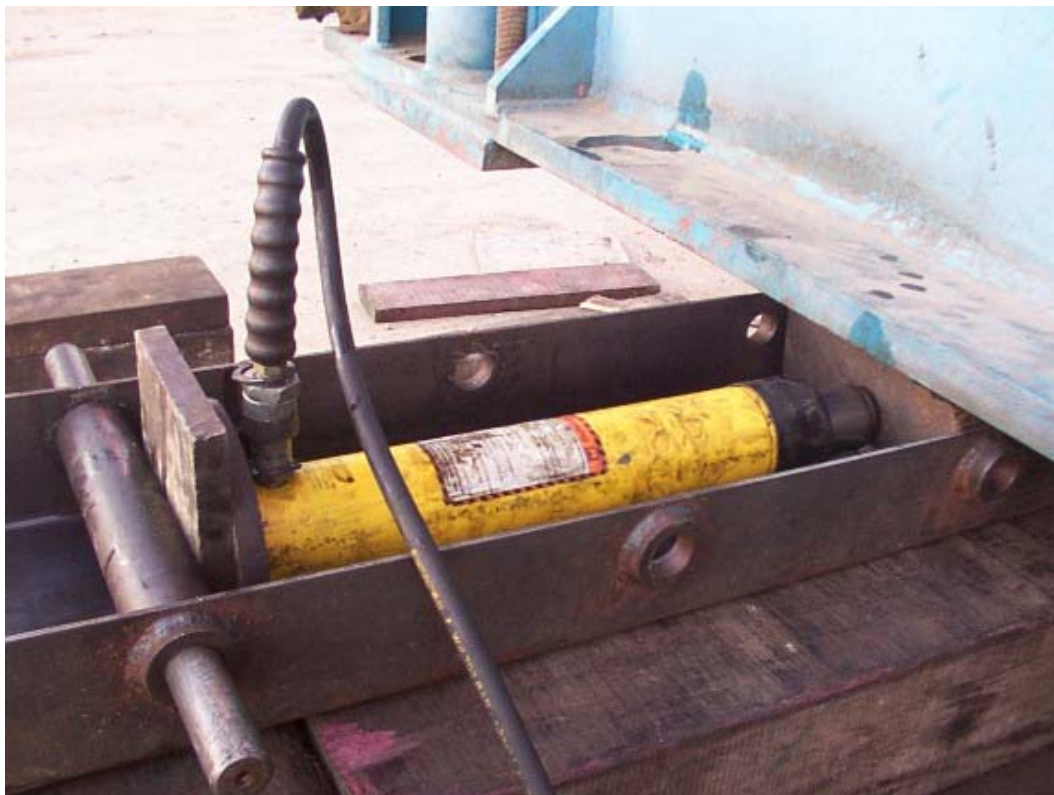
Figura 7.5, Gato hidráulico usado para desplazar los compartimentos horizontalmente
