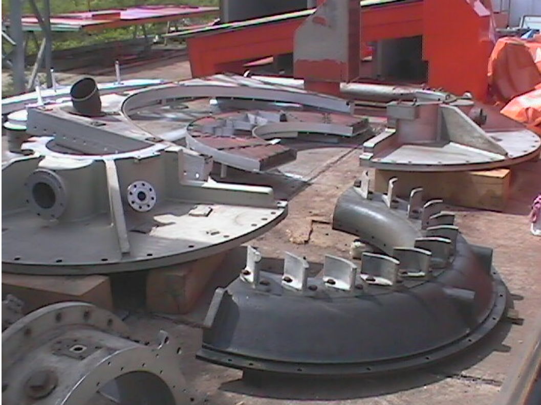
Figura 6.3, Partes y piezas a ser utilizadas en el mantenimiento mayor de una unidad MS-7001E (Planta Alfredo Salazar-Anaco)
