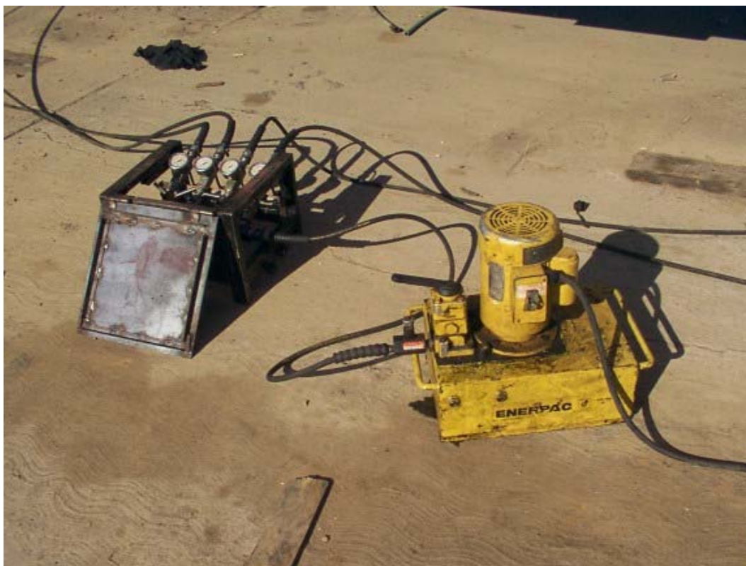
Figura 7.3, Bomba y divisor de flujo hidráulico para los gatos
