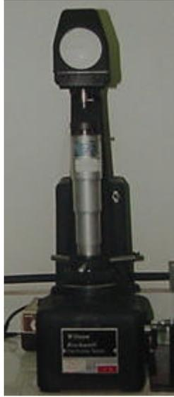
Fig. 14 Durómetro
