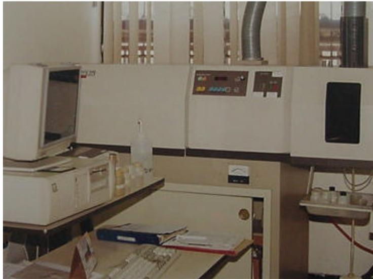
Fig 8. Equipo de espectrofotometria de emisión de plasma de argón tipo ARL 3410 ICP
