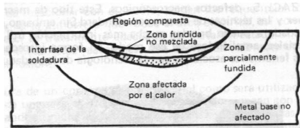
Fig 4. Zonas de un cordón de soldadura
