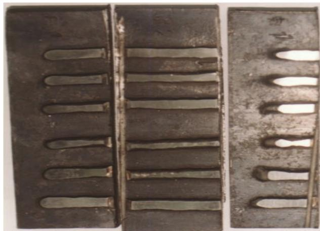
Figura 11. Corte en probetas para la realización de los cupones
