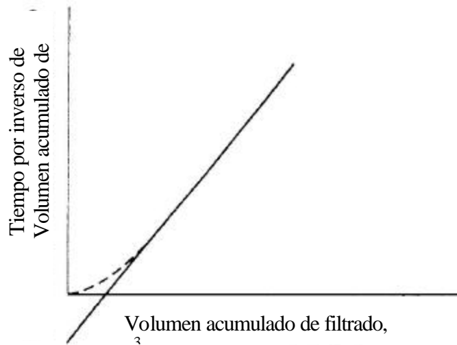
Figure 4.16 Gráfica de la ley modificada de proporción parabólica mostrando la intercepción negativa para una torta compresible.
