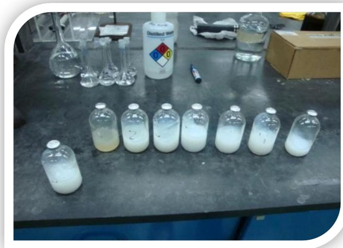
Figura 16. Pruebas de botellas para la determinación de la consistencia de la solución gelificante <sup>[5]</sup>
