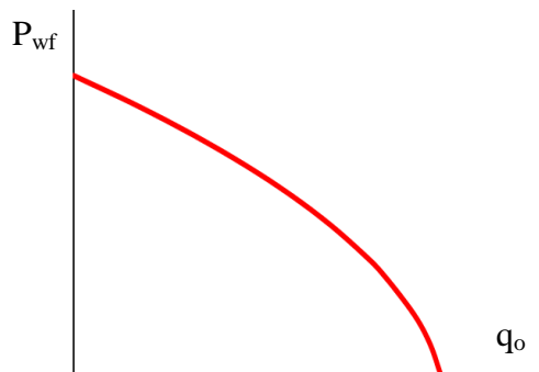
Figura 2.2. Curva IPR con IP variable, yacimiento saturado
