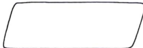
Bomba llena – Tubería no anclada o anclaje de tubería fallando
