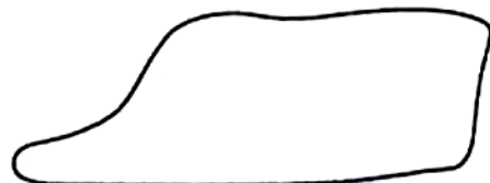
Cierre lento de la válvula viajera causado por emulsión de fluidos en la bomba
