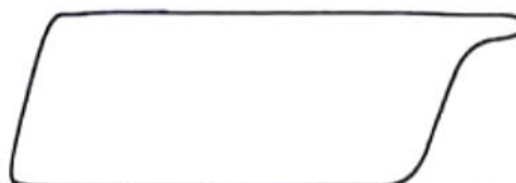
Ligero golpe de fluido – Tubería no anclada
