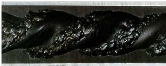
Figura 2.28. Elastómero afectado por una presión excesiva por etapas [25]
