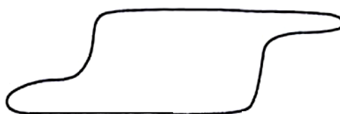
Combinación de golpe de fluido y cierre lento de la válvula viajera
