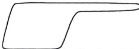
Severo golpe de fluido – Tubería no anclada
