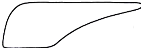
Interferencia de gas – Espaciamento del pistón muy alto desde el fondo
