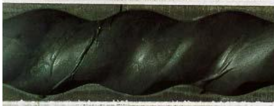
Figura 2.29. Elastómero afectado por arrastre de alta presión [25]
