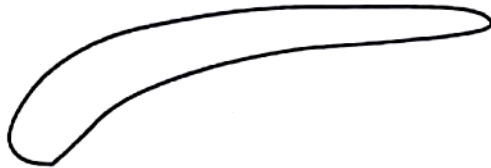
Bomba bloqueada por gas
