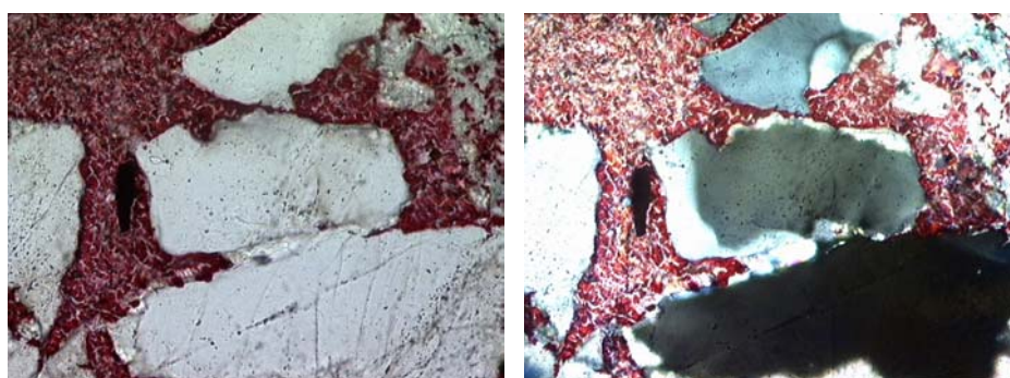
Figura 72: Sobrecrecimiento de cuarzo en continuidad óptica en Litofacies S1 (Muestra 10-85, Objetivo 20x, Nícoles II y X respectivamente).
