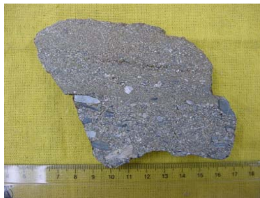
Figura 73: Gradación normal e imbricación en Litofacies S2 (Muestra 10-44).
