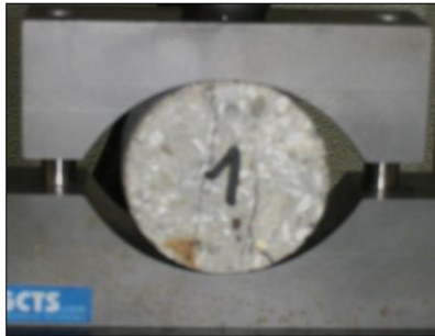
Figura 8 Esquema de ensayo brasileño. (Elaboración propia)
