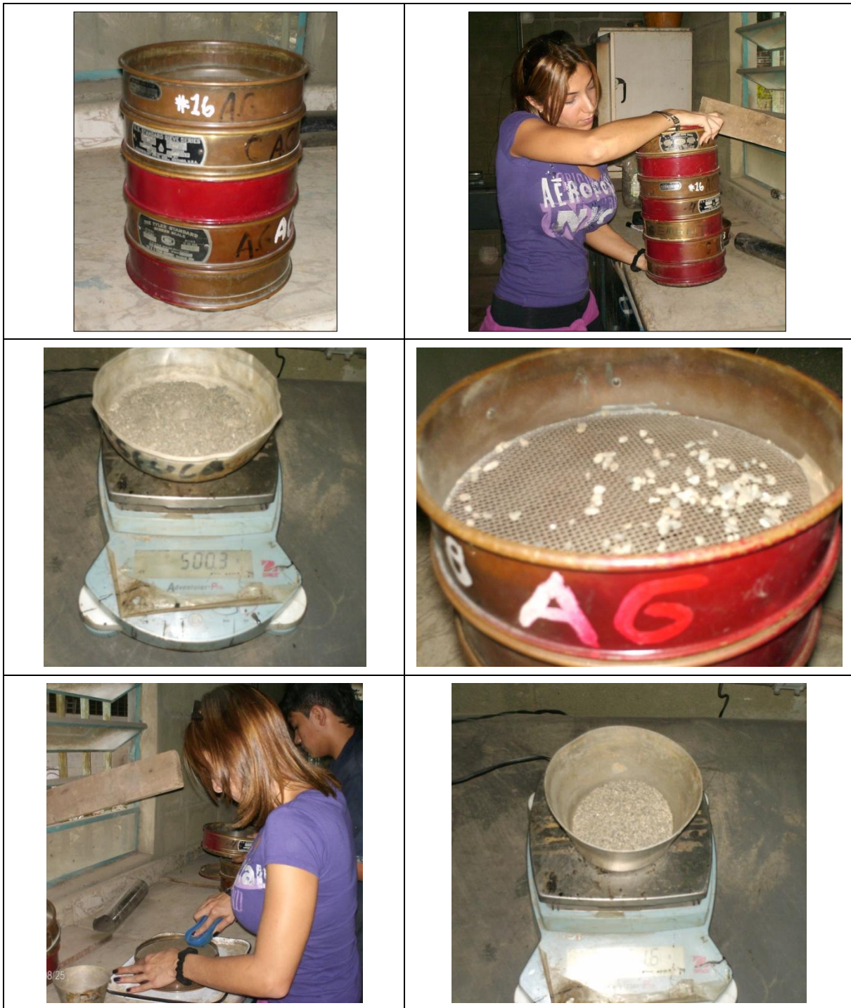
Figura 11 Proceso de tamizado para elaboración de la granulometría (Elaboración Propia)
