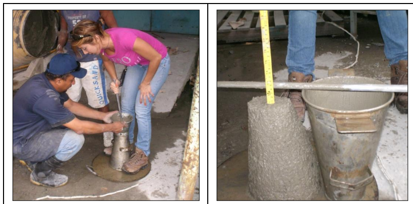
Figura 12 Proceso de medición del Asentamiento. (Elaboración propia)
