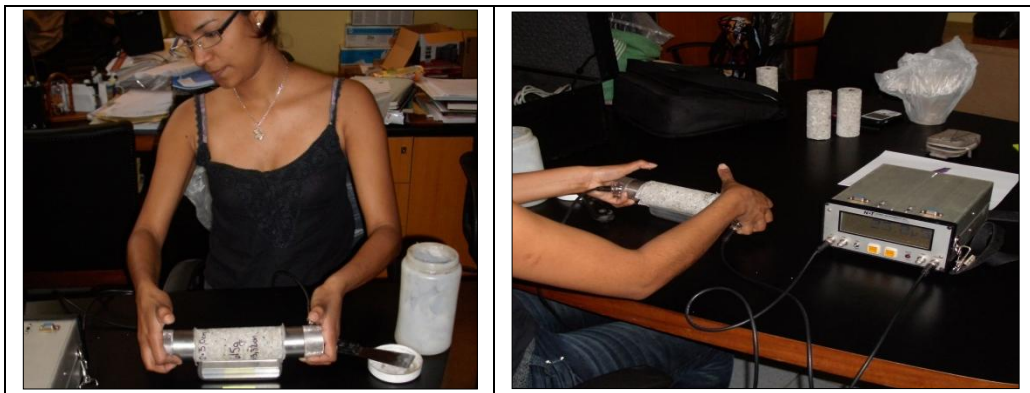
Figura 26 Ensayo de Ultrasonido en especímenes sin ensayar. (Elaboración propia)
