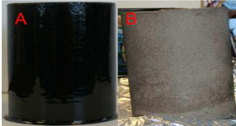
**Figura 22-C.1:** Núcleo impregnado con aceite (A) y después del proceso de recuperación por actividad microbiana (B) <sup>[117]</sup>
