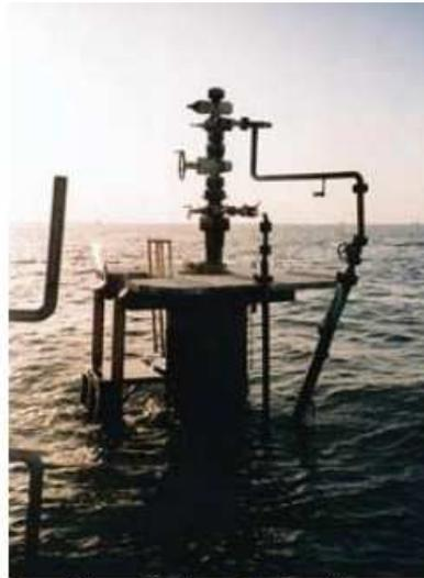
**Figura 23-D.1:** Pequeña plataforma de pozo de inyección en el Lago de Maracaibo [105]
