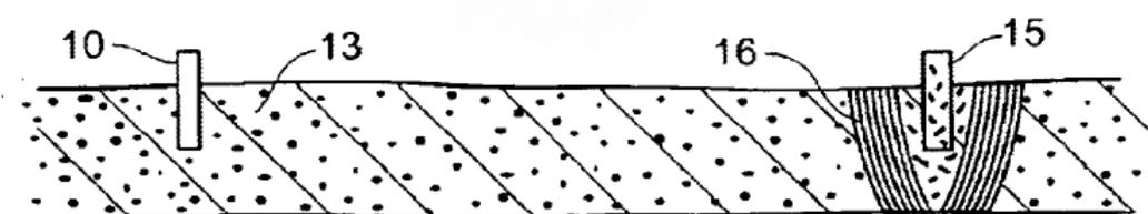
**Figura 32-E.4:** Petróleo desplazado por la biomasa y agua hasta el pozo productor [96]
