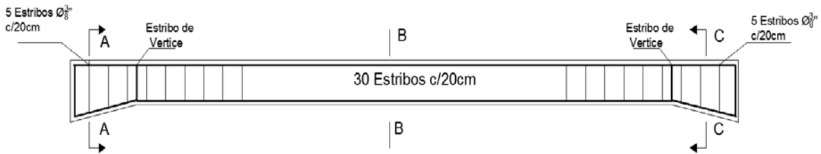
Fig. 4-428. Detalle del acero de la viga acartelada. Fuente: Elaboracion Propia
