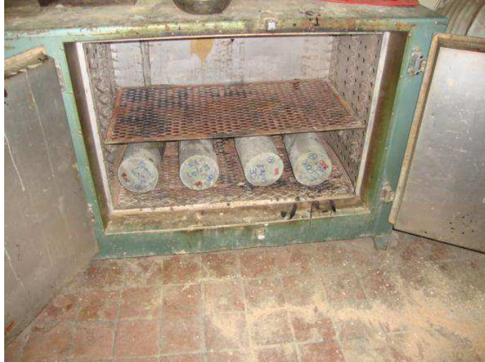
Figura III. 34. Aplicación de calor a los cilindros en el horno
