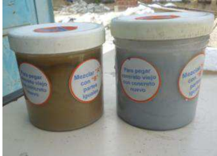
Figura III. 24. Componentes de resinas epóxicas A y B Fuente: Elaboración propia
