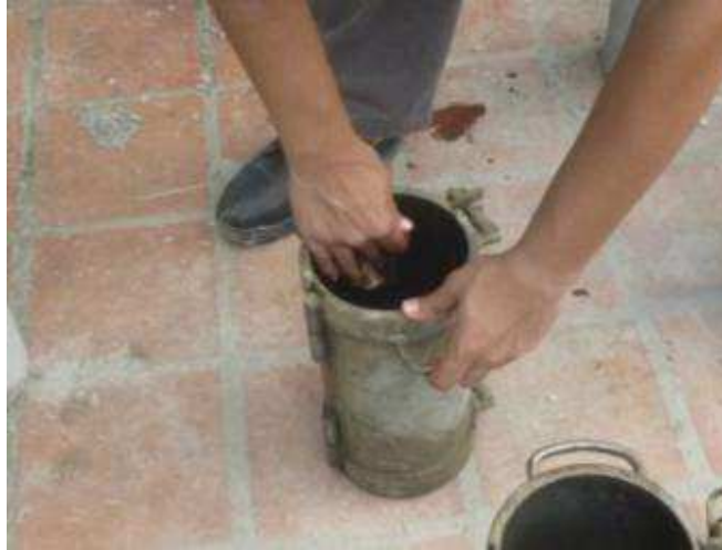
Figura III. 17. Engrasado de formaletas metálicas
