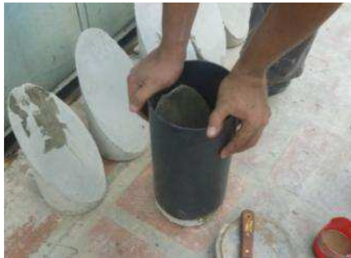
Figura III. 27. Introducción de las probetas Clase B1 en las formaletas cilíndricas
