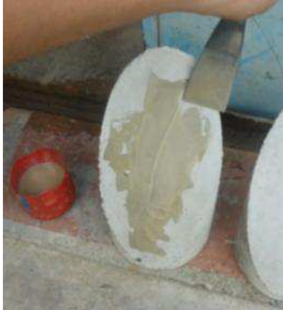
Figura III. 26. Aplicación del adherente epóxico
