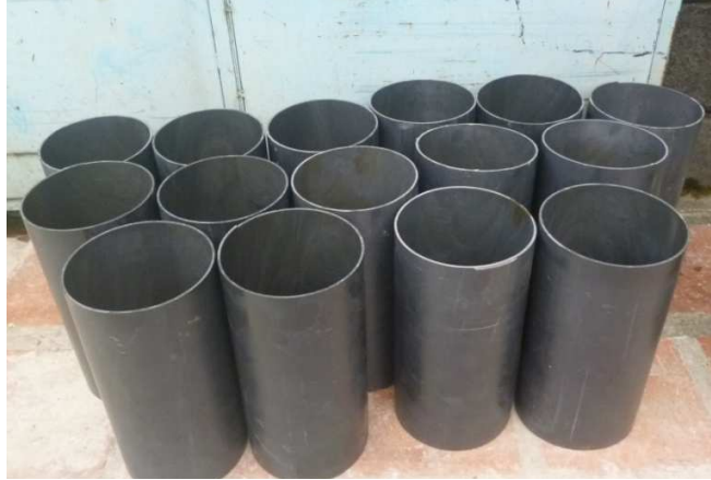
Figura III. 4. Tubos de PVC, tipo reforzado, diámetro interno 6”
