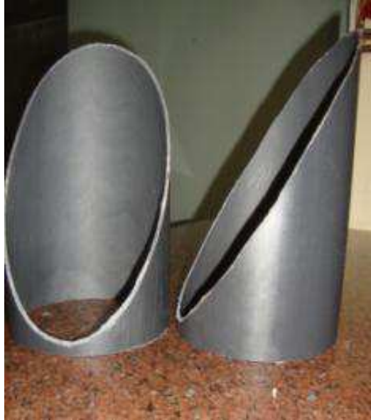
Figura III. 11. Formaletas cilíndricas con corte a treinta grados
