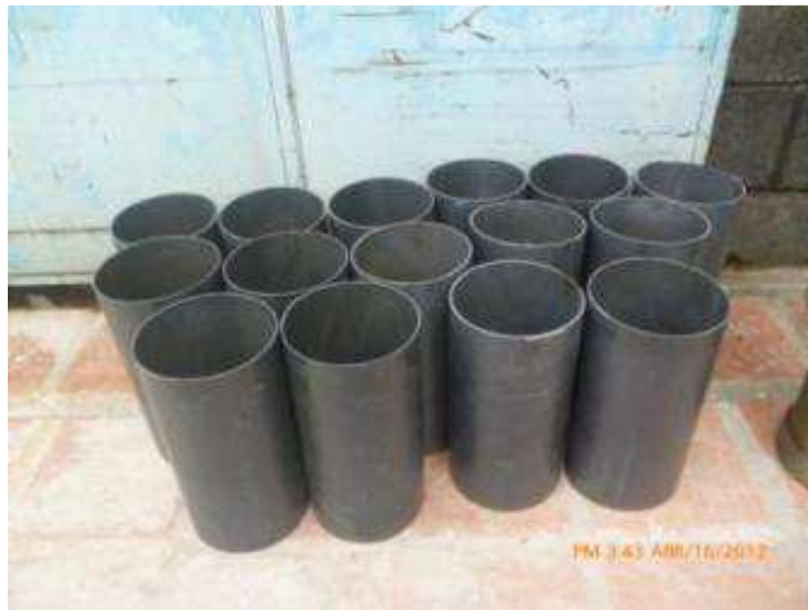
Figura III. 13. Formaletas cilíndricas con corte a noventa grados
