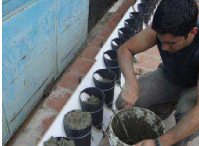
Figura III. 20. Vaciado de probetas Clase B1
