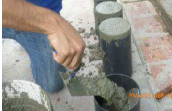
Figura III. 28. Vaciado de las probetas B2
