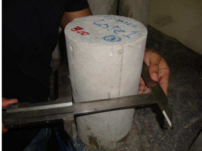
Figura III. 32. Medición del diámetro de los cilindros
