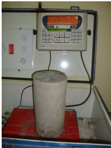
Figura III. 33. Pesajes de los cilindros
