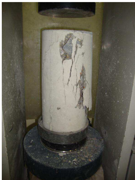
Figura III. 36. Falla de una probeta Clase A1
