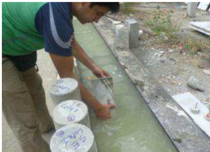
Figura III. 31. Colocación de las probetas B2 en la piscina de curado
