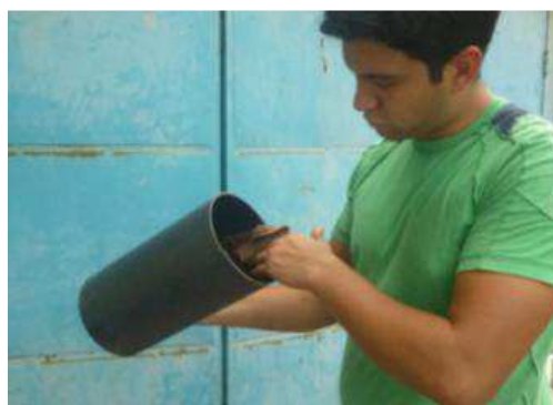
Figura III. 23. Engrasado de formaletas cilíndricas para la elaboración de las probetas Clase B2
