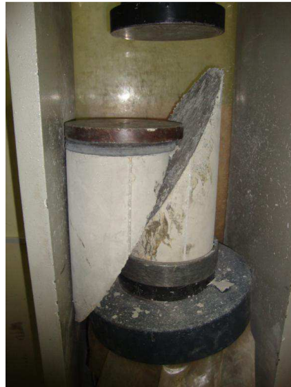
Figura III. 35. Falla de una probeta Clase B2
