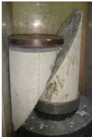
Figura V. 1. Falla de la probeta vaciada en dos etapas.
