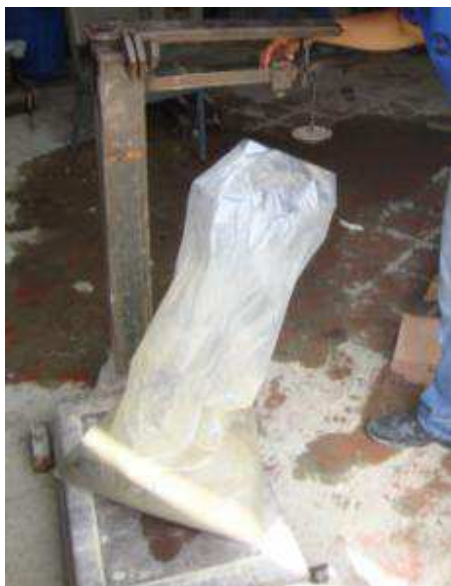
Figura III. 14. Elaboración de la mezcla, pesaje del agregado fino
