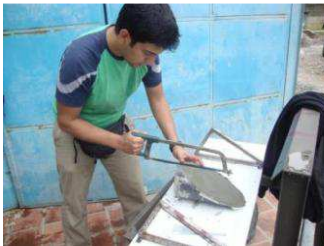
Figura III. 21. Desencofrado de probetas Clase B1
