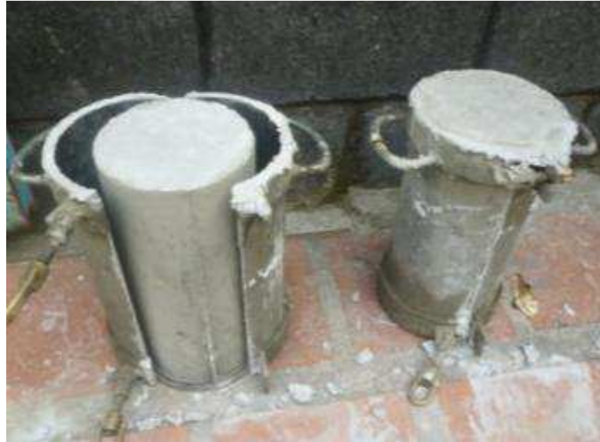
Figura III. 18. Desencofrado de probetas testigos
