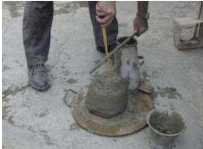
Figura III. 16. Medición del asentamiento a través de ensayo Cono de Abrams
