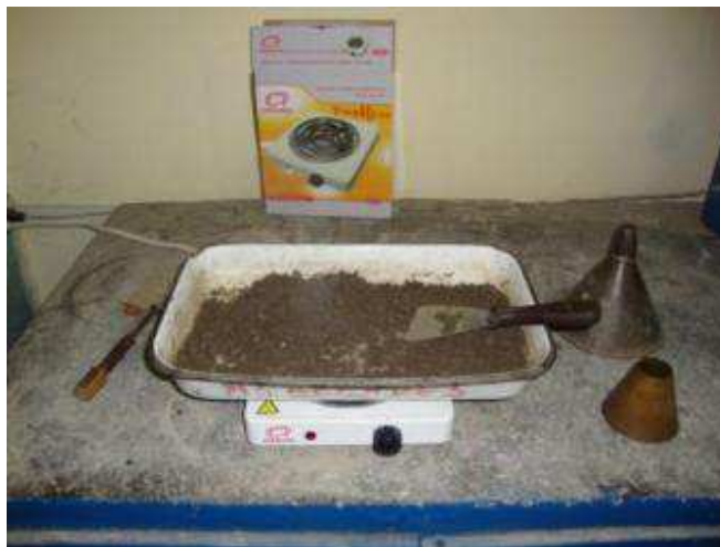
Figura III. 7. Peso específico, secado del material fino
