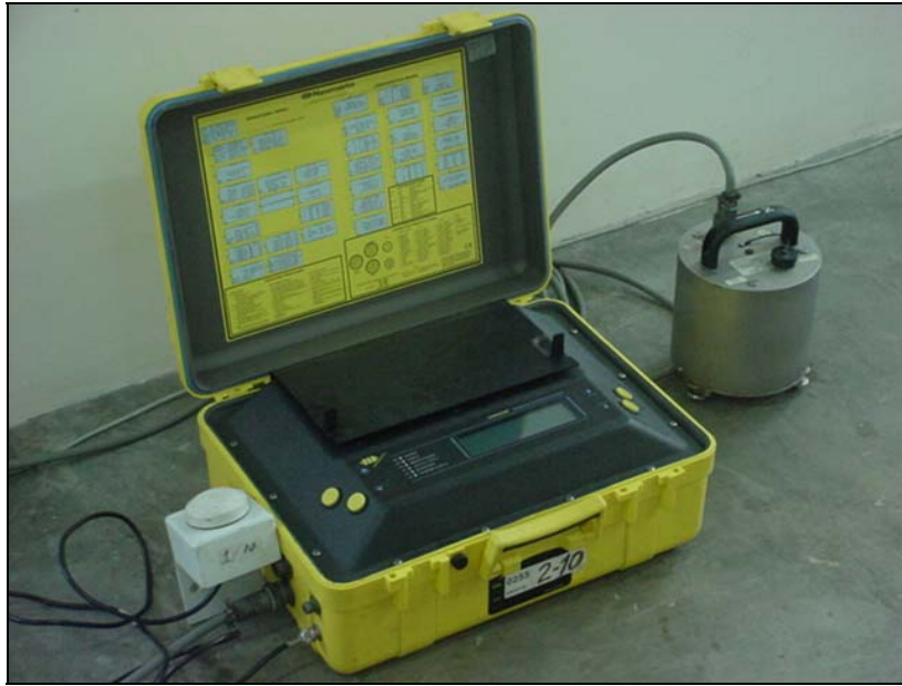
Figura 4.1: Configuración de una estación sismológica portátil. Esta consiste de un sismógrafo portátil (maletín amarillo), un sismómetro (cilindro gris) y su respectivo GPS (cubo blanco)
