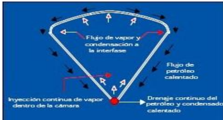
Fig. 2.6 Cámara de Vapor
