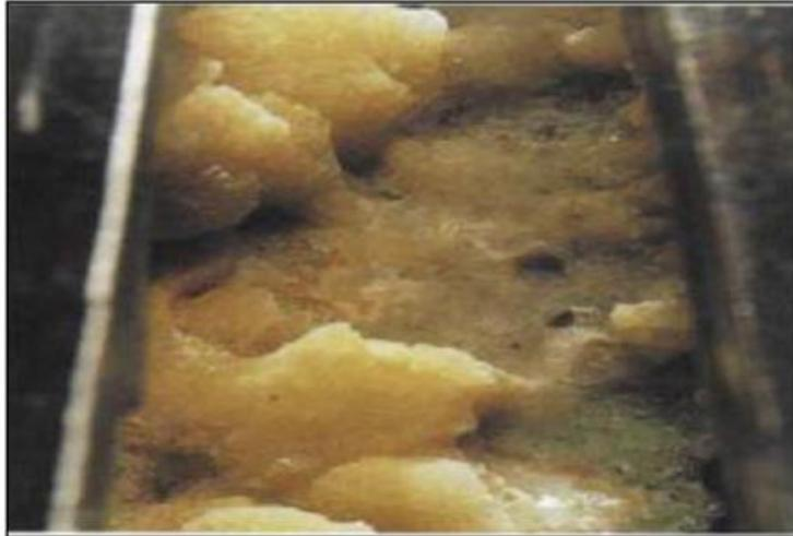
Figura VI.8. Escamas de carbonato de calcio o calcita en la tubería de producción.
