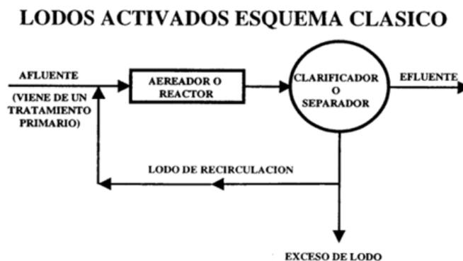
FiguraVI.3. Esquema general de las unidades que conforman el proceso de lodos activados
