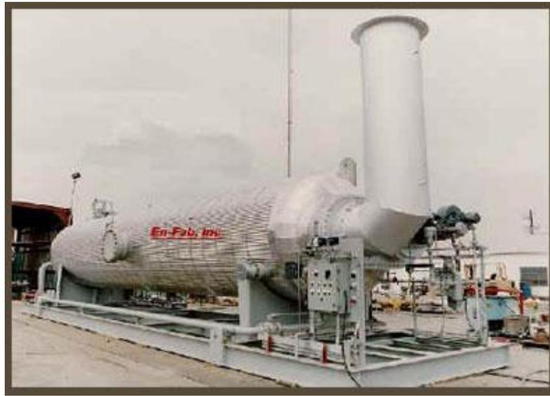
Figura V.6. Heater-treater (Tratador con calor)directo tipo horizontal en campo
