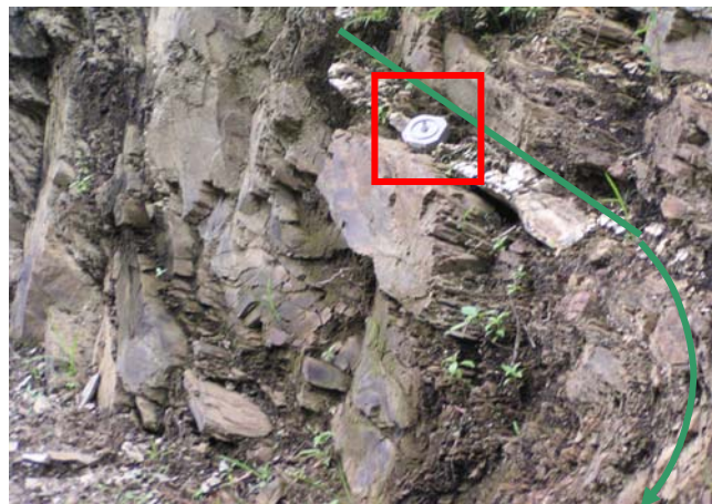
Fig. 48: Talud T19-2-28, plegamiento local asociado a la deformación en régimen dúctil del material.
