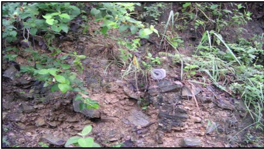
Fig. 20: Disposición de los cantos pertenecientes al coluvión, embebidos en una matriz limo arcillosa.
