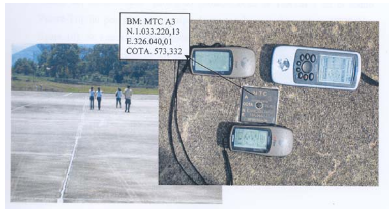
Fig. 3: Calibración de equipos de Posicionamiento Global.
