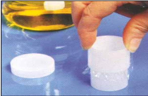
Fig. 41. Ejemplo de preparación de portamuestras para el análisis del polvo utilizando Maylar
