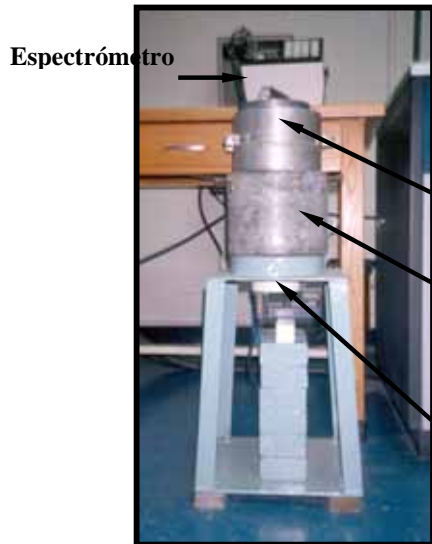
Fig 36. Foto del dispositivo de medición, donde se observa la disposición de los anillos de plomo.
