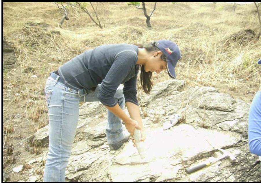
**Figura 5.1.** Ensayo con el Martillo de Schmidt o Esclerómetro
