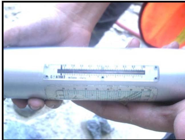
**Figura 5.2.** Medición de resistencia con el Martillo de Schmidt o Esclerómetro.
