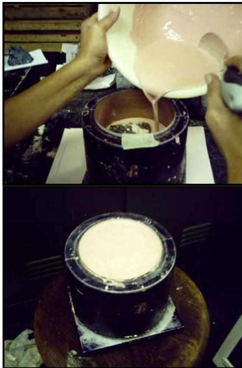
**Figura 6.12.** Montaje de la muestra para ensayo corte directo
