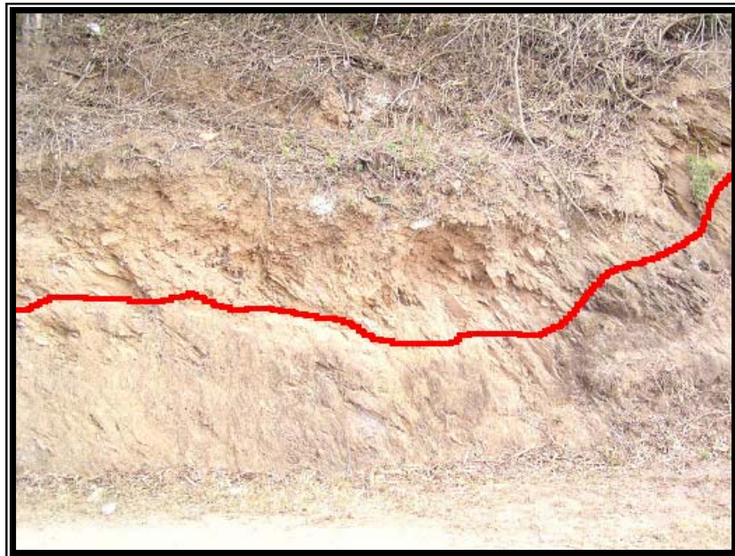
Fig. 31: UEQM al tener menor contenido en cuarzo y mayor % de humedad, el macizo exhibe un perfil en el que desarrolla un horizonte IV (bajo la línea roja) según Deere & Patton. Roca Mala según RMR Bieniawski (1987).
