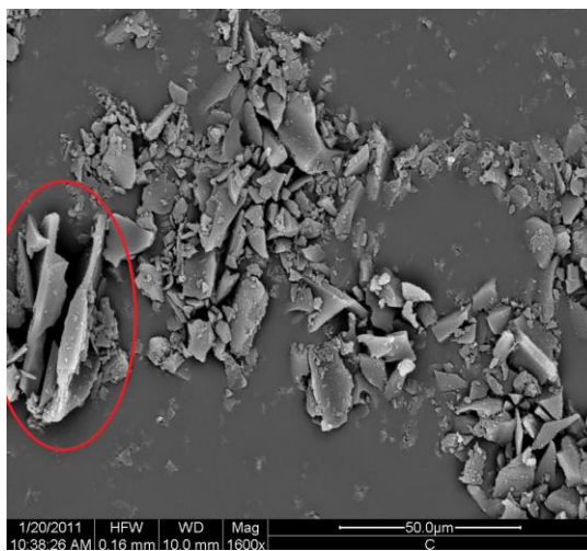
Figura 66. Microscopía Electrónica de Barrido de los soportes: (a) Carbón Riedel de Haens (Micromaraca: 50µm) y (b) Cnorit (Micromaraca: 20µm).
