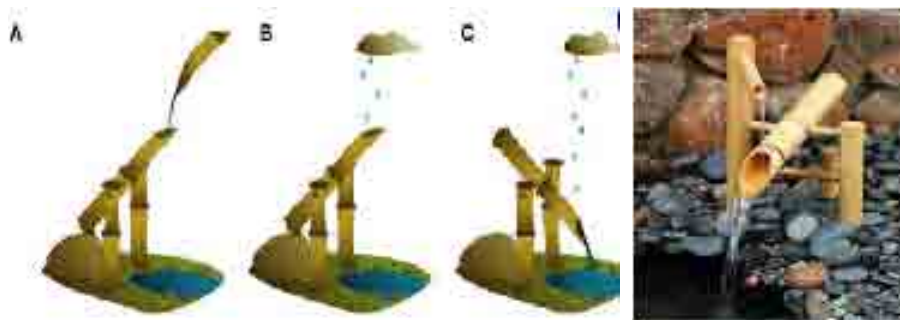
Figura 137. Shishi Odoshi, a la izquierda mecanismo de movimiento. Cortesía de Malela Suarez
