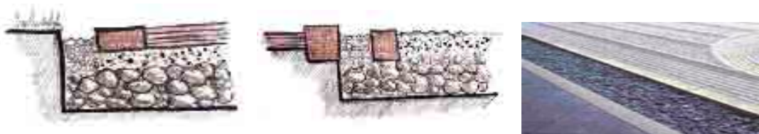
Figura 192. Área de drenaje en borde del jardín. Jardín, drenaje, brocal, acera de circulación (izquierda). Acera, brocal, drenaje, grava (centro). Acera, brocal, drenaje, brocal y grava (derecha). Foto cortesía de Kikku Fukushima. Figuras Mitzi Winkler
