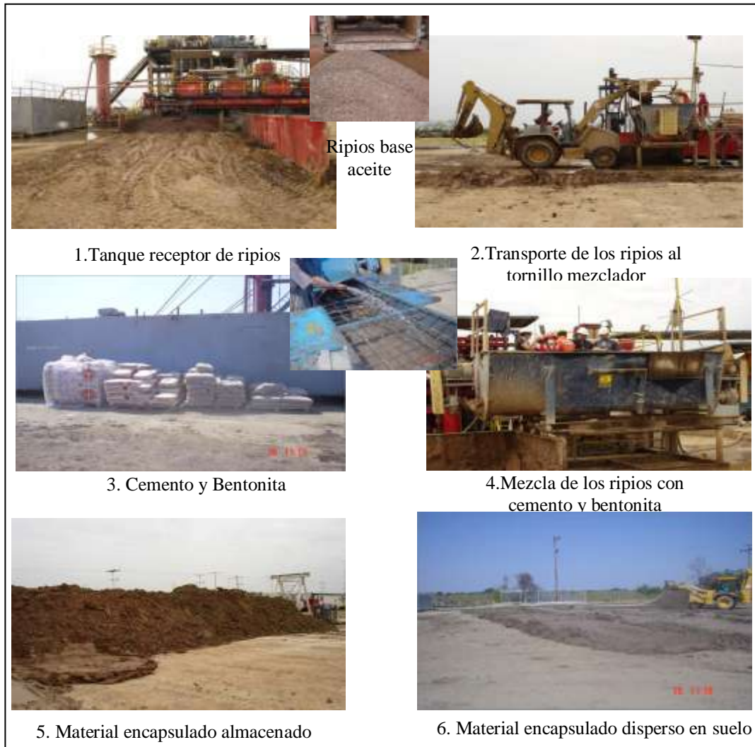
Figura N° 08. Fotos del tratamiento del rípio con Endrill, estado Barinas
