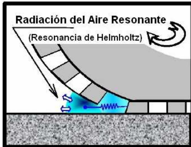
Fig. 3.8 Amplificación de Sonido causado por resonador de Helmholtz.
