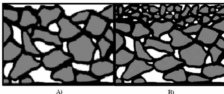
Fig. 3.12 A) Esqueleto de piedras de un asfalto poroso de una capa, B) Esqueleto de piedras de un asfalto poroso de doble capa,
