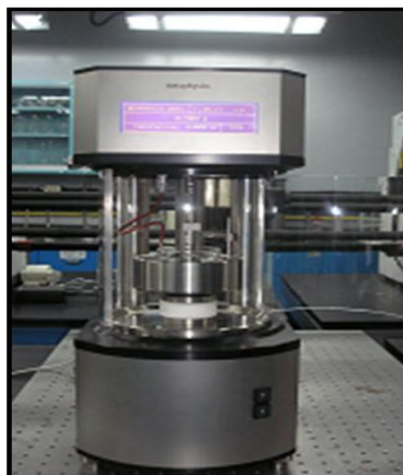
Figura 3.11: DCAT11 de DataPhysics, método de la Placa de Wilhelmy para la determinación de tensiones superficiales en medio acuoso.
