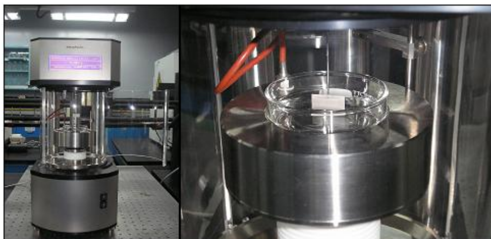
Figura 3.14: Montaje del ensayo de de tensión superficial por el método de la placa de Wihelmy, [Hernández, 2012]
