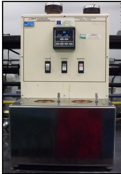
Figura 3.6: Equipo para acondicionar los sistemas cementante, [Hernández, 2012]
