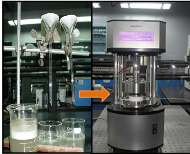
Figura 3.15: Montaje del ensayo para medir la tensión interfacial sólido-líquido, [Hernández, 2012]
