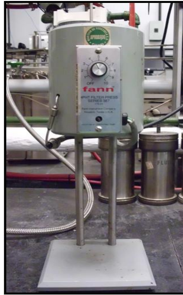
Figura 3.8: Equipo para la medición de la pérdida de filtrado [Hernández, 2012]
