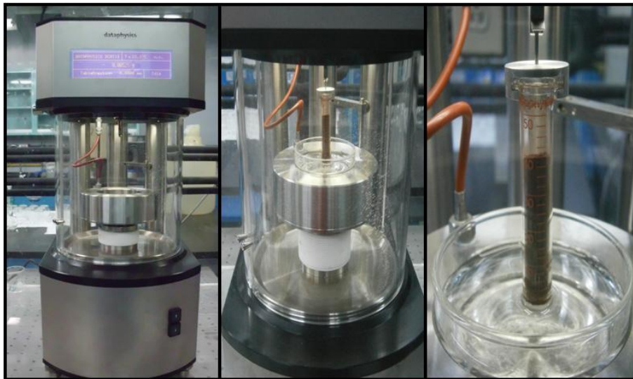
Figura 3.17: Montaje del ensayo para calcular el ángulo de contacto sobre as partículas de cemento, [Hernández, 2012]
