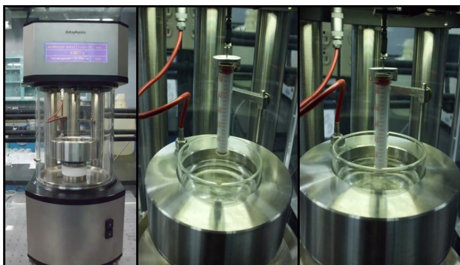
Figura 3.16: Montaje del ensayo para calcular el ángulo de contacto sobre las partículas de LITECEM ® , [Hernández, 2012]
