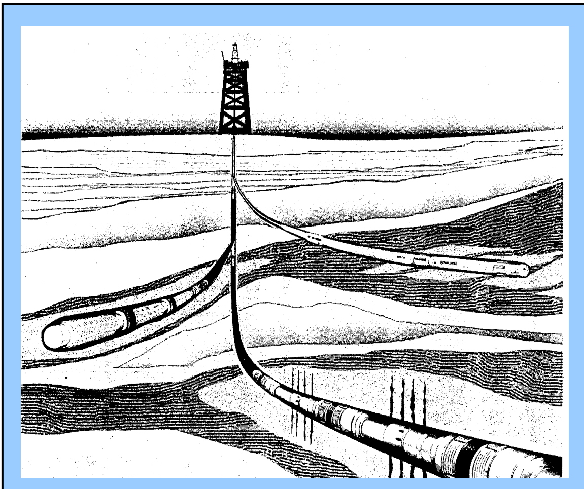
Figura 3.9. Aplicación de los Pozos Multilaterales.
