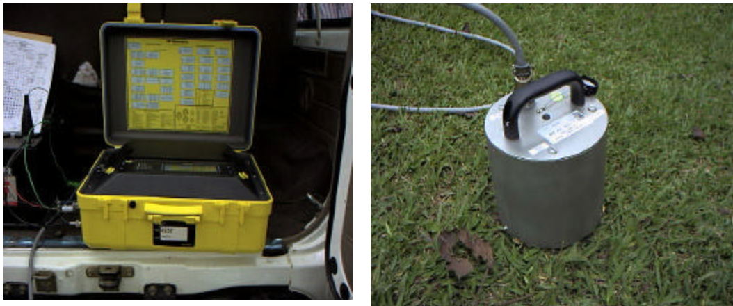
Fig. III-h: Izquierda: Nanometrics modelo Orion-3S . Derecha: sensor Guralp modelo CMG-T40-0008 con rango de frecuencia 30 segundos – 50 Hz
