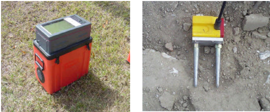
Fig. III-b: Izquierda: Geometrics Strata View de 48 canales. Derecha: receptor horizontal con frecuencia natural de 30 Hz
