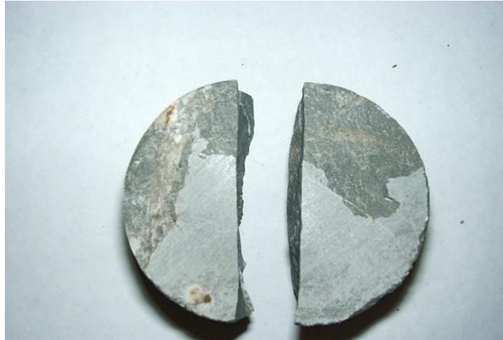
Fig. 27 Fractura Típica de Ensayo de Tracción Indirecta
