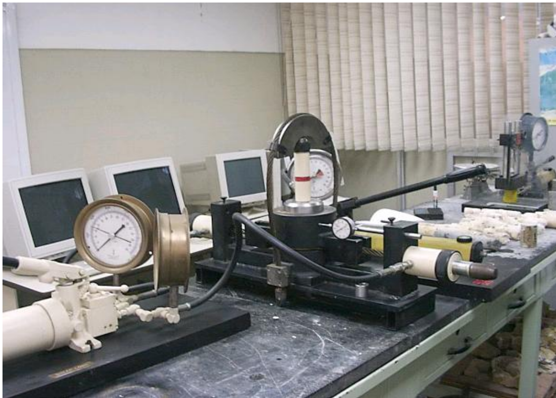
Fig. 29 Equipo de Corte Directo, SBEL, RM-102. Laboratorio de Mecánica de Rocas, U.C.V.
