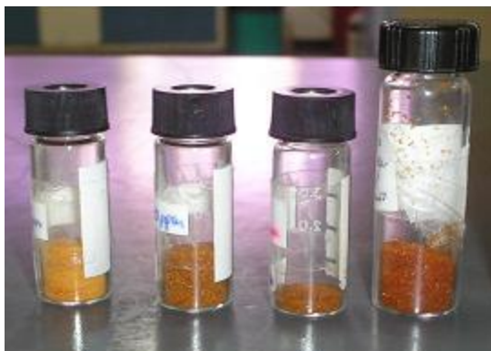
Figura 12. Muestra de Catalizadores Mo, NiMo, CoMo
