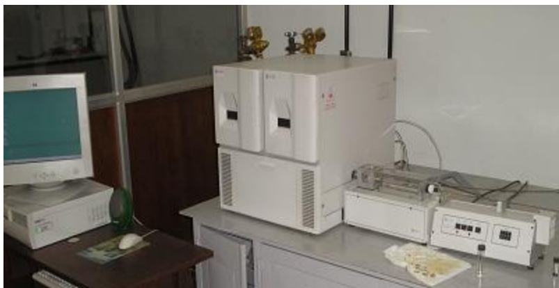
Figura 13. Equipo ANTEK utilizado en la determinación del contenido de S y N 2 en las muestras de gasóleos antes y después de la reacción.
