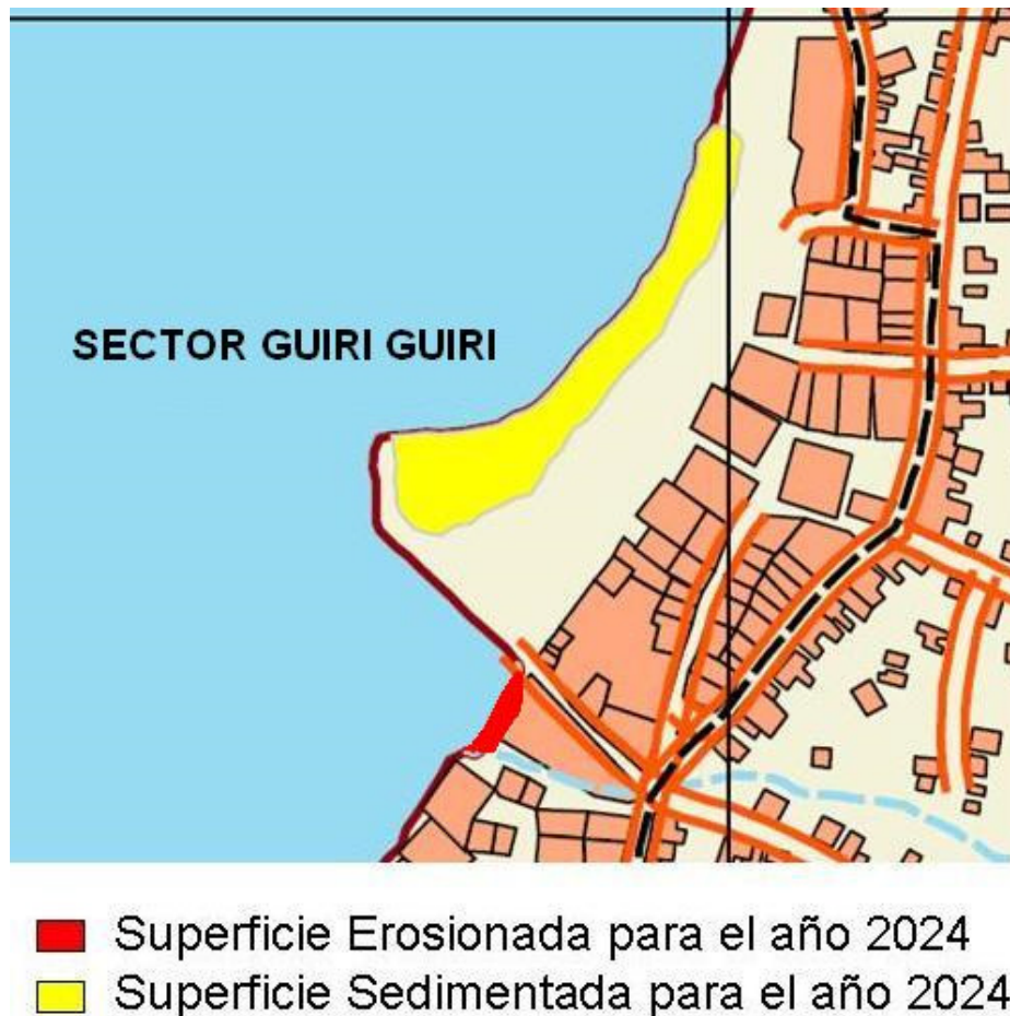
Imagen N° 5. Superficie erosionada y/o sedimentada en el sector Guiri-Guiri. Año 2024
