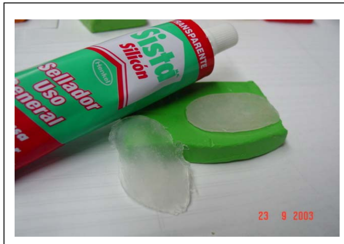
Figura 46. Huella artificial realizada con sellador transparente de silicona
