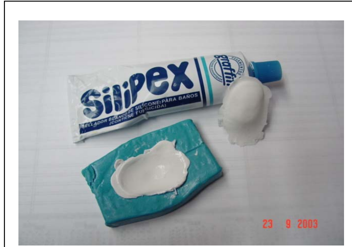
Figura 45. Huella artificial realizada con sellador blanco de silicona.
