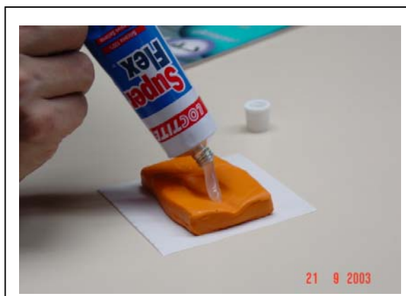
Figura 40. Relleno del molde con silicona.
