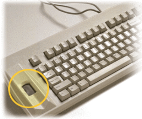
Figura 22. Lector óptico integrado en un teclado (Keytronic de Identix).
