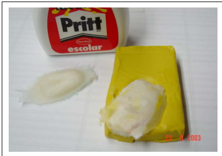
Figura 47. Huella artificial realizada con cola blanca
