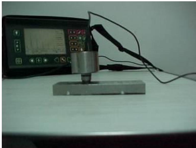
Fig. 22 Montaje de la pesa sobre los transductores durante las mediciones.
