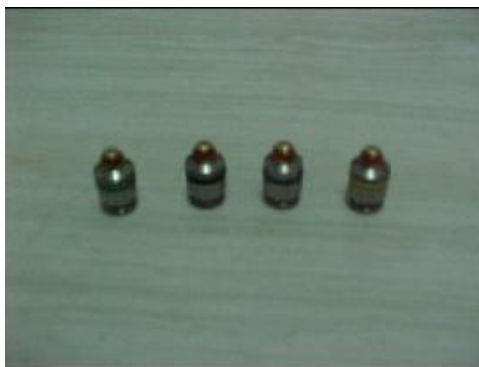
Fig. 17 Transductores fabricados por Krautkrämer de 0.25" de Diámetro
