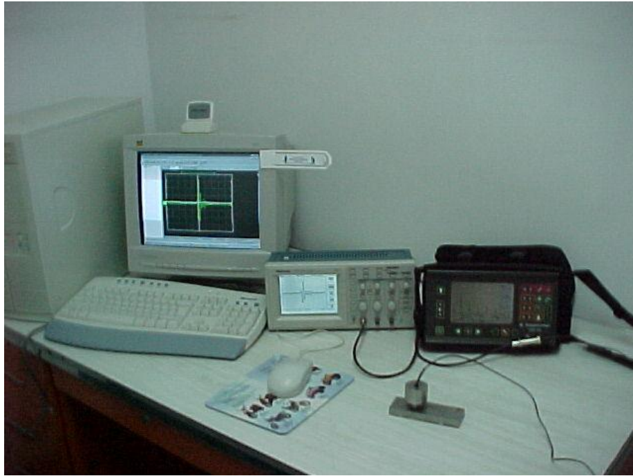
Fig. 21 Montaje experimental de la adquisición de la data para espectros de frecuencia
