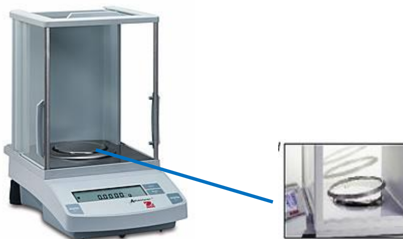
Ubicación del platillo de la balanza OHAUS®, modelo Adventurer™
