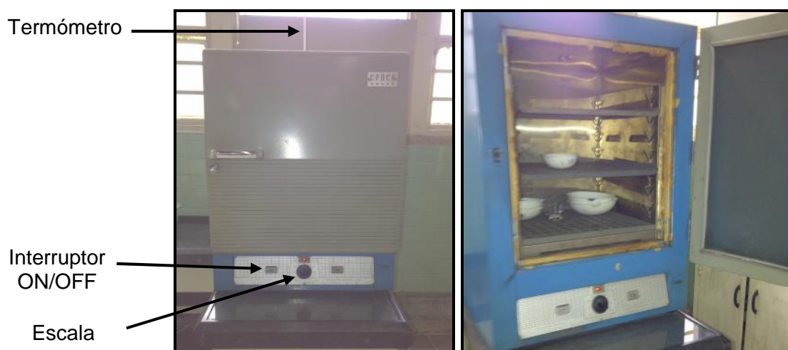
Fotografías de estufa de calentamiento, vista exterior e interior respectivamente
