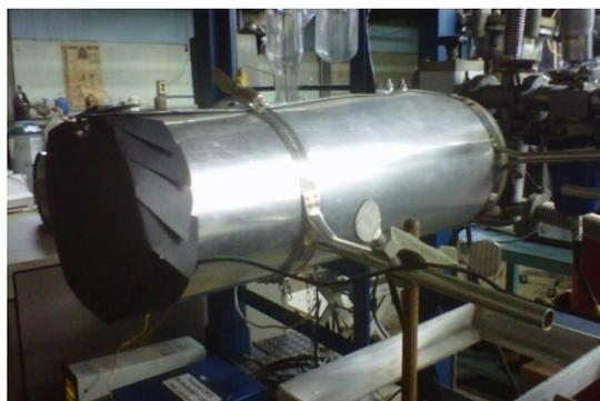
Figura N° 19: Cilindro para el control de la luz en el sistema de visión artificial del manómetro analógico.
