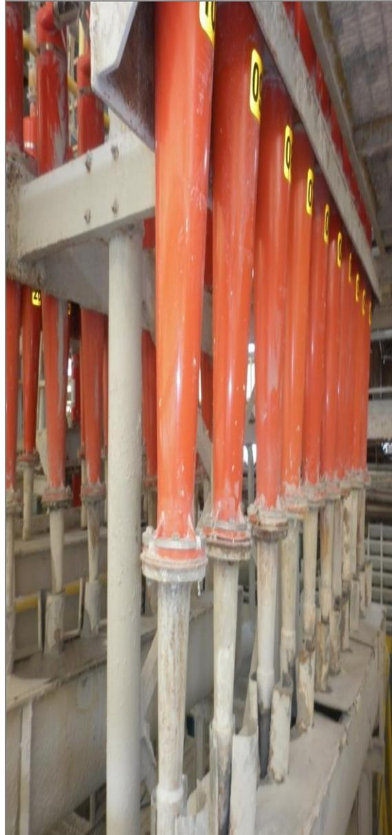
**Figura N° 30 A. Componentes del Limpiador centrifugo de baja densidad.** (Kimberly- Clark, 2004)
