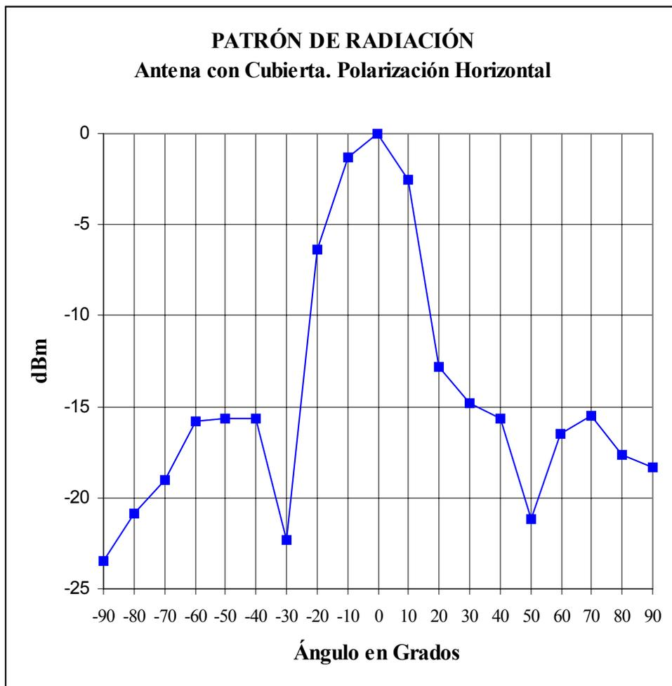
Gráfico 4. Patrón de radiación de la antena con la cubierta. Plano  $\phi = 90^\circ$
