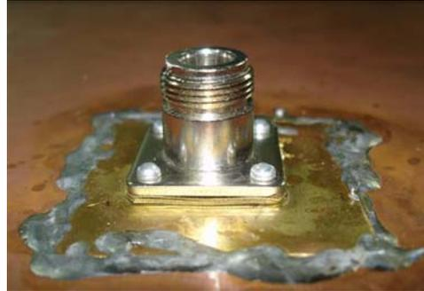
Figura 16. Fotografía de un conector N adaptado a una antena planar.
