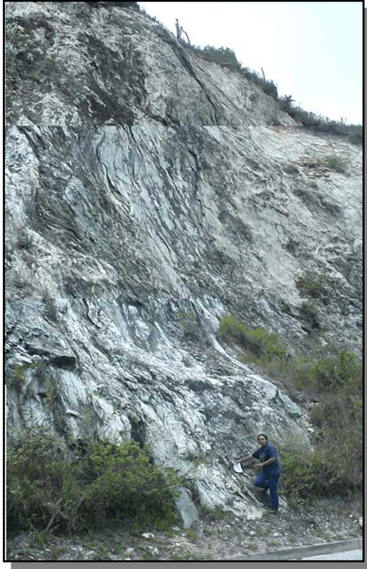
Fig.143. Foliación concordante parte feldespática y anfibolita. Esquisto cuarzo micáceo granatífero, con intercalaciones de 3 mts de anfibolita con 1 metro aproximado de feldespato. Asociación Metamórfica Ávila, sin diferenciar (A). Ocumare de La Costa (Hoja, 6647-III-NE).
