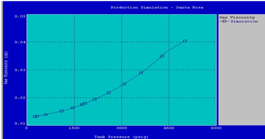
Fig 4.2.1. Comportamiento de la Viscosidad del Gas en Función de la Presión
