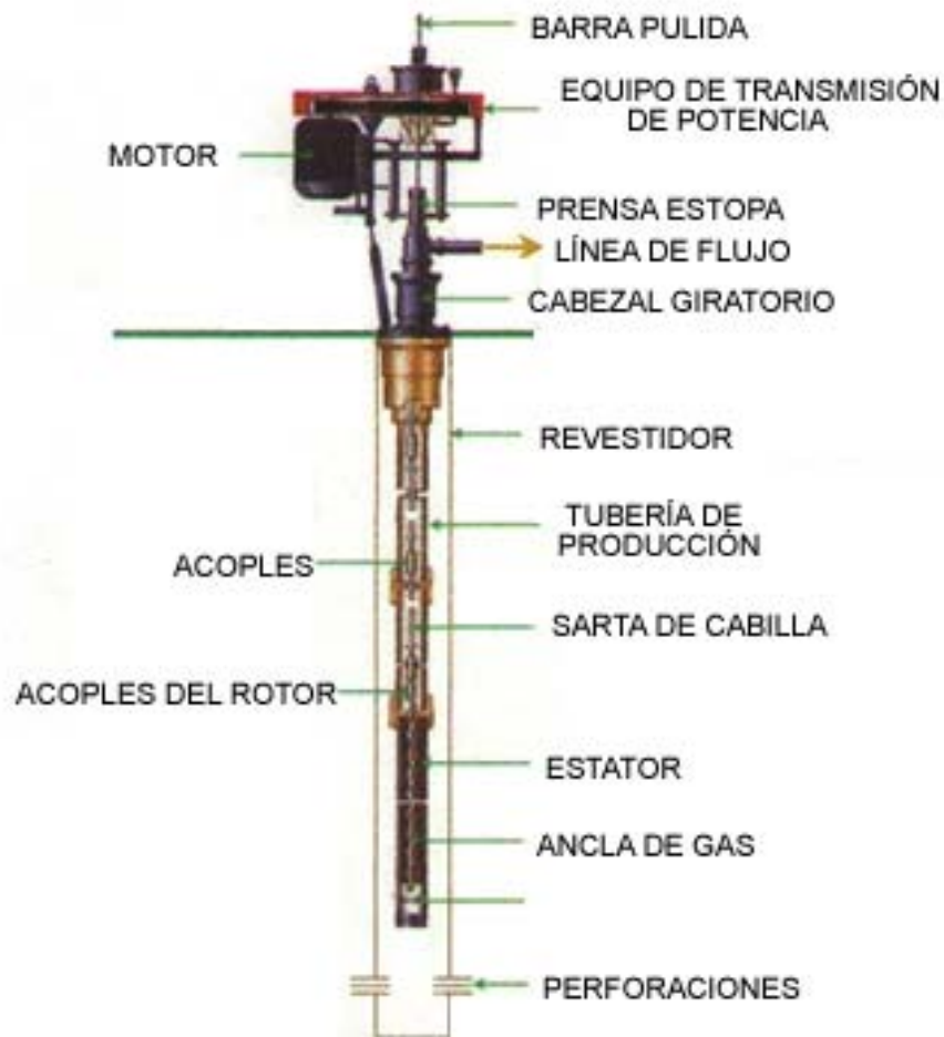
Fig.6.2 Componentes de un Sistema Típico de Bombeo por Cavidades Progresivas
