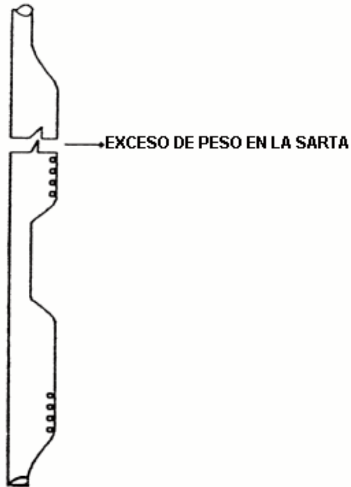
Fig. 5.34 Falla por Tensión
