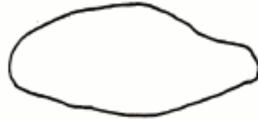
BOMBA DESGASTADA VIAJERA FIJA O PISTÓN FUGANDO
