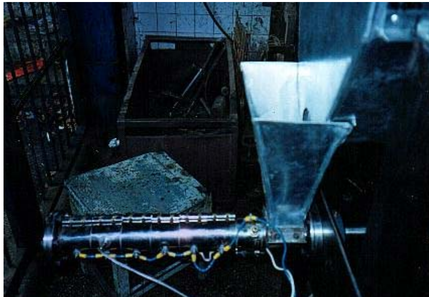
Fig. 7.2 Vista lateral del cañón. Podemos observar las conexiones en serie de las siete resistencias eléctricas de banda, las cuales suministran el calor requerido al alimento mientras pasa por el interior del cañón
