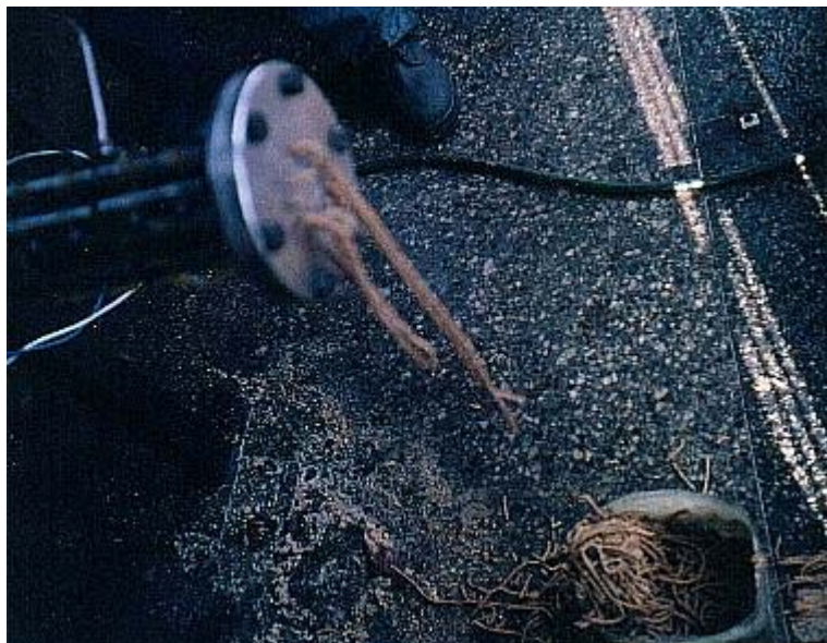
Fig. 7.8 Puesta en marcha de la máquina. En esta prueba podemos observar como salen los filamentos por los orificios de la matriz. Estos filamentos son el resultado de la mezcla de las harinas con la inyección de agua que ocurre dentro del cañón, además del aumento de temperatura que recibe dicha mezcla mientras son transportados internamente por el tornillo extrusor. En la parte inferior derecha se encuentra un envase donde caen los filamentos. Debido a la fragilidad de estos filamentos, los mismos pueden ser partidos en pequeños pelets con tan sólo darles vuelta dentro de este envase, llevándolos a la condición deseada.
