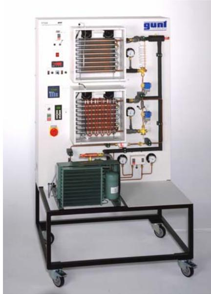
Fig 4.1. Regulación de Potencia en Plantas Frigoríficas” ET-426. Fuente: Internet [4.1]
