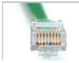
El conector RJ-45 es el componente macho, engarzado al extremo del cable
