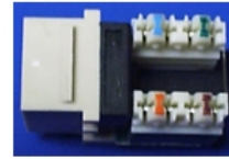
Conexiones a presión en la parte posterior del jack donde se conecta el cable Ethernet UTP
