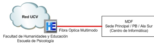
Figura 19: Instalación de la fibra óptica entre la FCJP y la Facultad de Humanidades y Educación.
