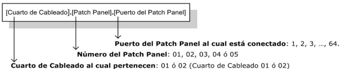
Figura 39: Formato de identificación de los wallplates de la empresa CODSU Sistemas
