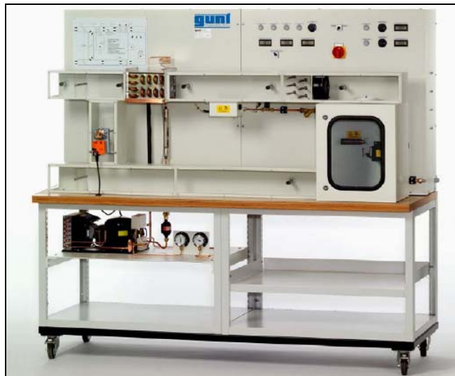
Figura 4.2 – Adiestrador de aire acondicionado con recirculación (GUNT). Fuente www.gunt.de
