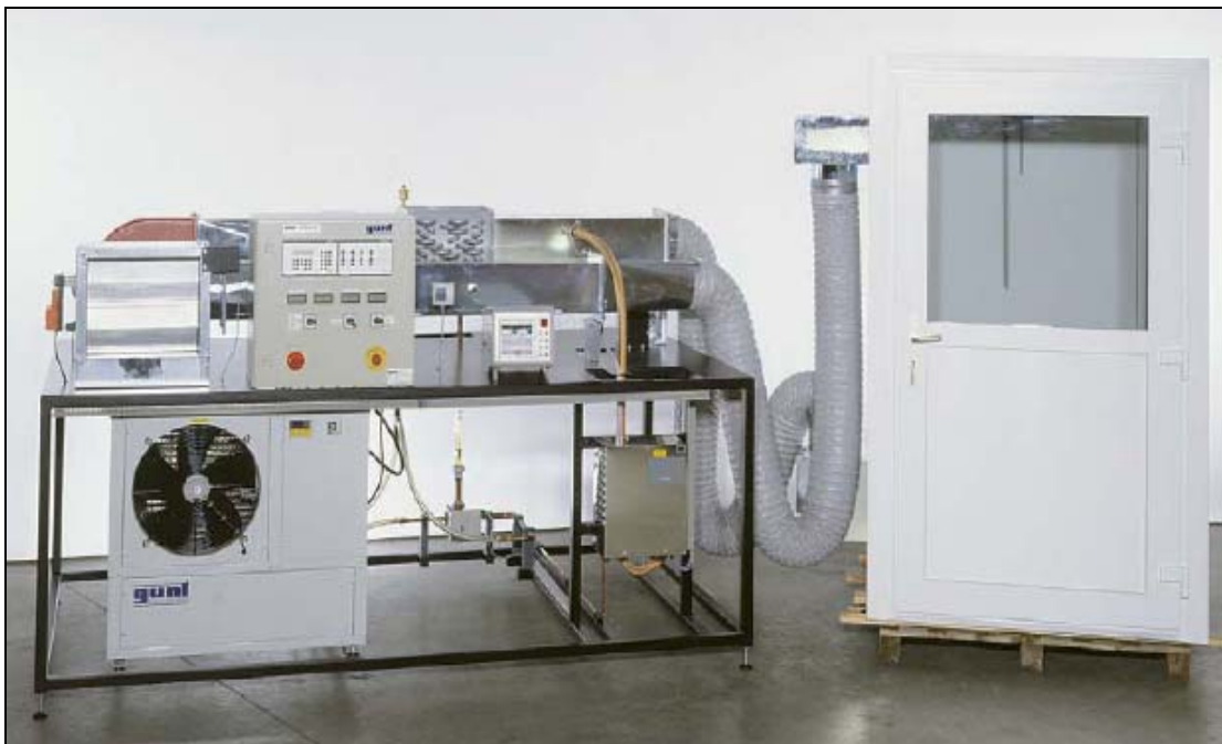
Figura 4.3 – Sistema de aire acondicionado con cámara climatizada (GUNT). Fuente www.gunt.de
