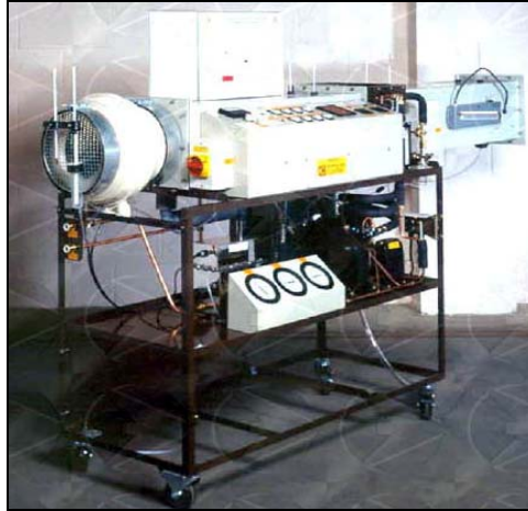
Figura 4.4 – Unidad de aire acondicionado A660. Fuente www.p-a-hilton.co.uk
