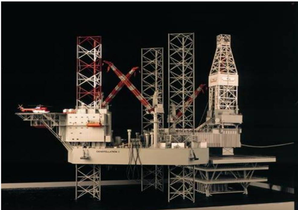
Figura III.16. Plataforma semi-fija o *Jack-Up*.<sup>[19]</sup>
