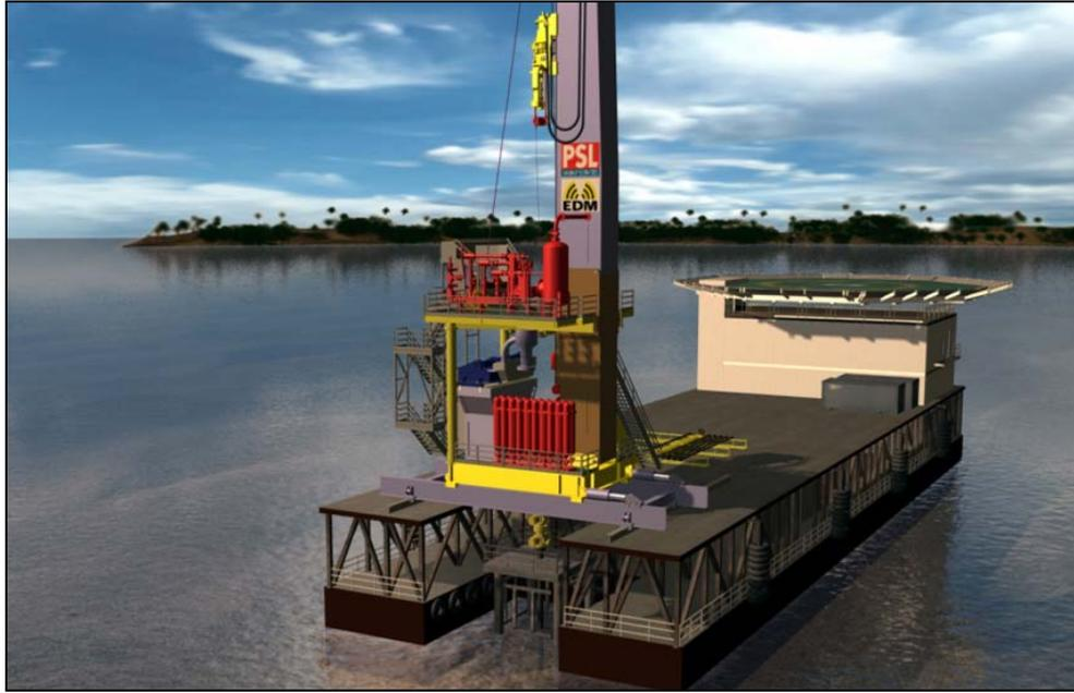
Figura III.10. Unidad de perforación costa afuera en aguas lacustres, gabarra de perforación <sup>[19]</sup>
