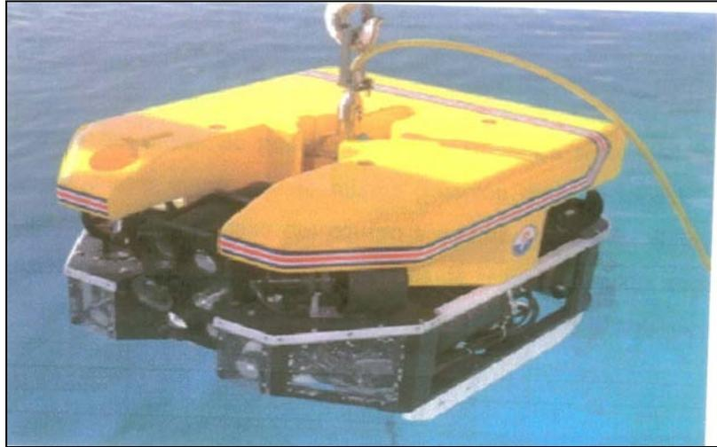
Figura III.44 Vehículo operado a control remoto o ROV <sup>[20]</sup>
