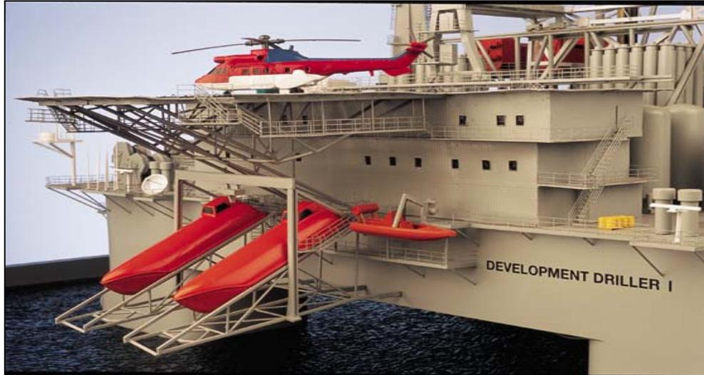
Figura III.46. Sistemas de evacuación existentes en plataformas petroleras costa afuera. <sup>[19]</sup>
