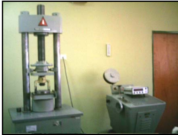
Figura N° 17: Fotografía de la prensa hidráulica para la resistencia a la compresión.
