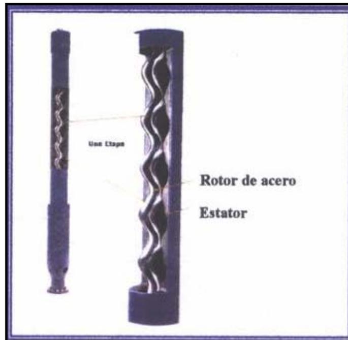
Figura 2.5: Bomba de Cavidad Progresiva (BCP).
