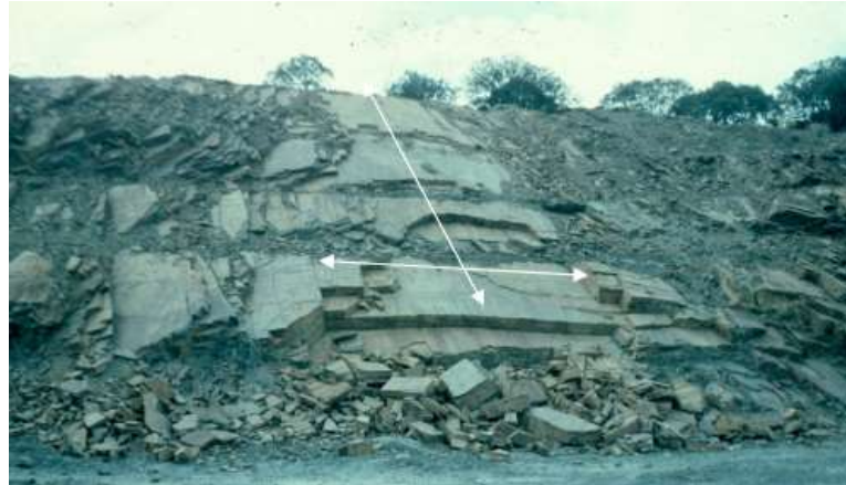
Figura 15. Continuidad o persistencia superficies estudiadas en los afloramientos. Tomado de Alejanos Et al. (s.f)
