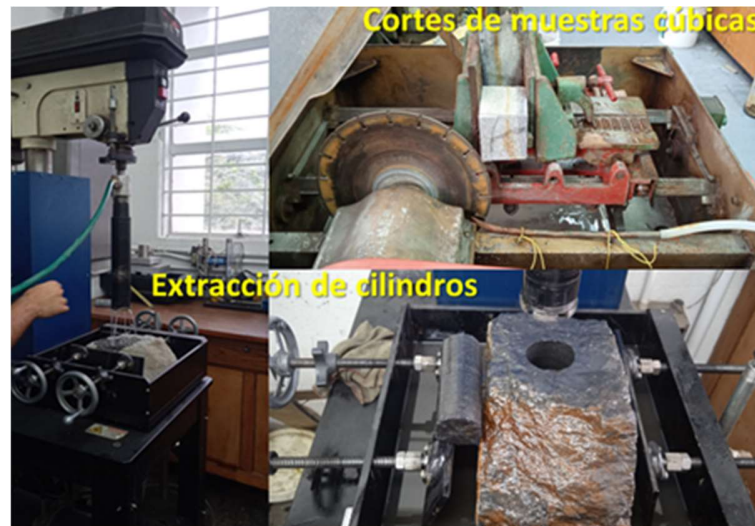
Figura 26. Extracción y corte de las muestras
