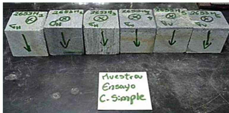
Figura 27. Rotulado de muestras para ensayo a la Compresión Simple.
