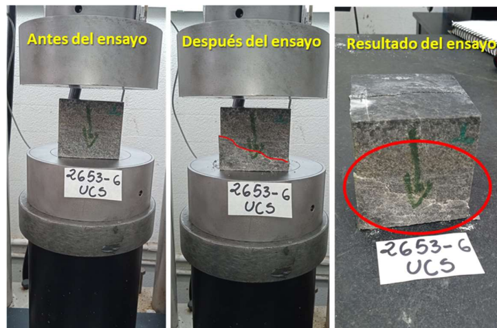
Figura 37. Resultado del ensayo a la Compresión Simple para la muestra 2653-6.
