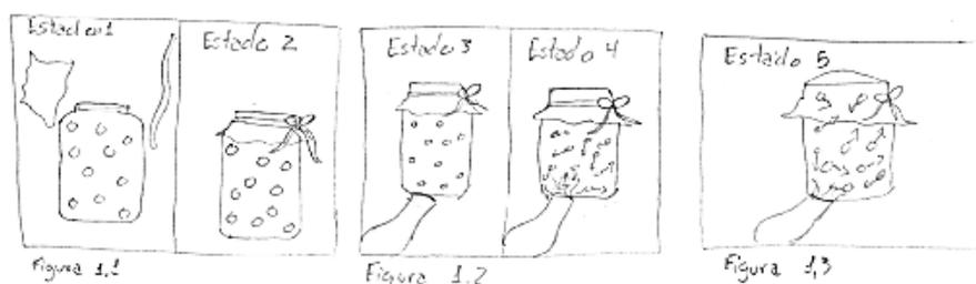
Luego de tener el frasco ya sellado se toma un secador de cabello, se pega la punta del secador a la base del frasco y se enciende en su máxima temperatura para así transferir al frasco una temperatura mayor a la que ya tenía [Ver figura 1.2]. Al cabo de unos minutos se puede apreciar como el papel envoplast se expande gracias a que el gas que está dentro del frasco aumentó su volumen debido al aumento de temperatura [Ver figura 1.3]
