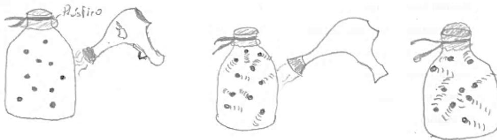
Todo esto pasa por las leyes de los gases de Charles, según Charles la temperatura es directamente proporcional al volumen, esto explica porque el volumen aumentó cuando el aire caliente actuó sobre el frasco. Los átomos y moléculas del aire chocan con las paredes del frasco haciendo que el papel plástico se expanda por efecto de la presión.
