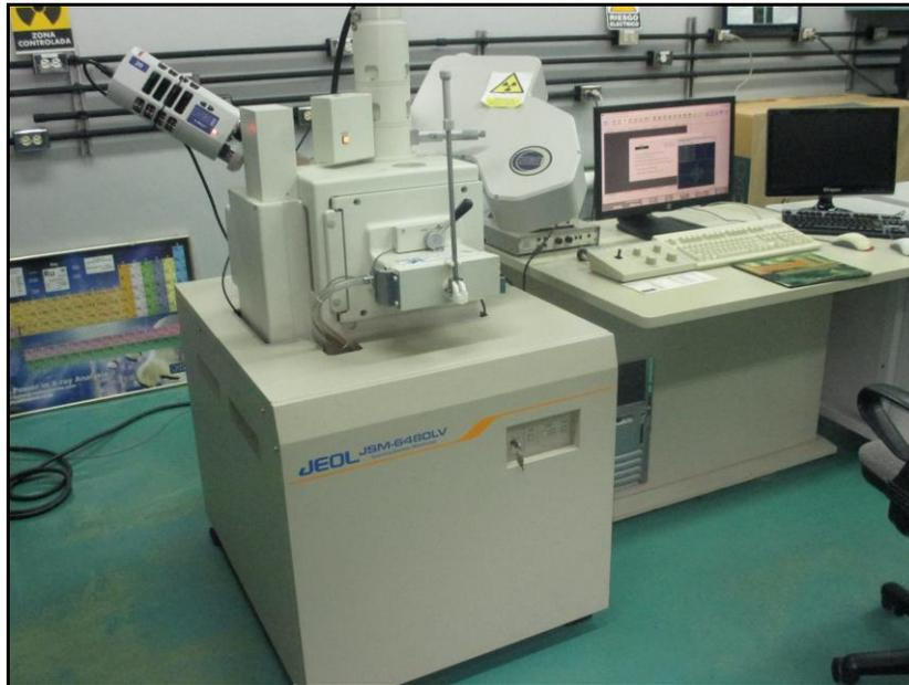
**Figura 3.16** Microscopio Electrónico de Barrido. Pdvsa Intevep
