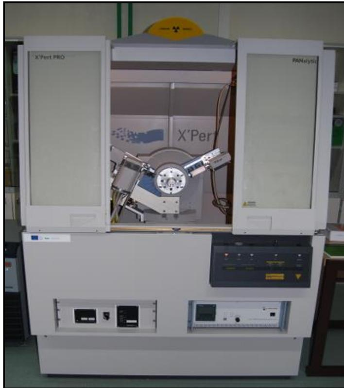
**Figura 3.18** Difractómetro de rayos X. gerencia de Química Analítica de PDVSA - INTEVEP
