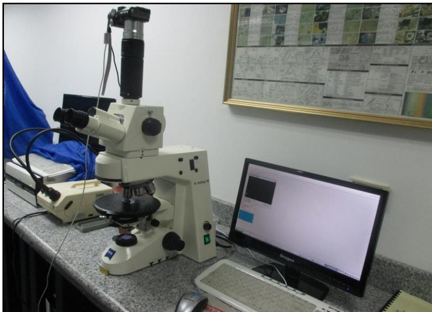
**Figura 3.21** Microscopio petrográfico. Gerencia de exploración PDVSA-INTEVEP
