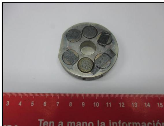
**Figura 3.17.** Porta muestras con minerales pesados montados para MEB después de *Picking*
