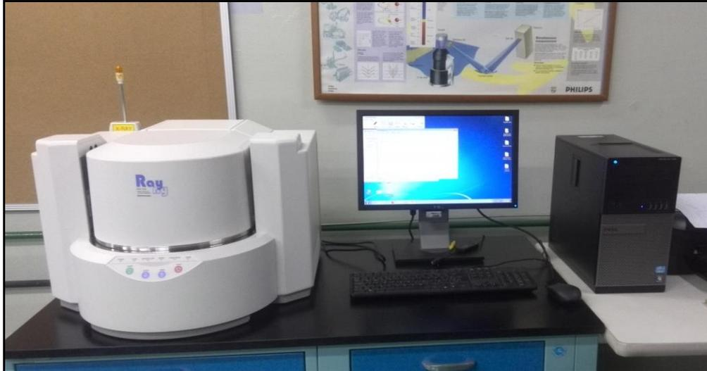
Figura 3.19 Equipo de Fluorescencia de Rayos X, Laboratorio de Mineralogía de INGEOMIN
