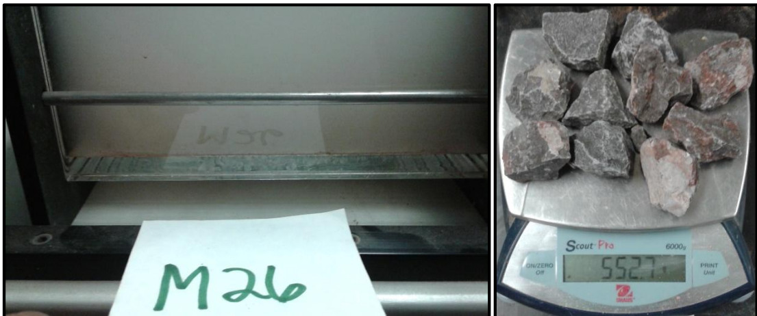
Figura 4.24. Procedimiento del Slake Durability Test a muestra Pica 4 - M26 de caliza medianamente pura. A) Tara de los diez fragmentos posterior al primer ciclo de secado. B) Peso resultante del primer ciclo de humectación y secado. C) Peso resultante del segundo ciclo de humectación y secado.
