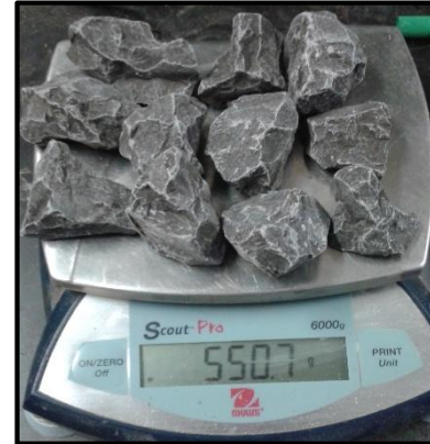
Figura 4.23. Procedimiento del Slake Durability Test a muestra de caliza Pica 1 - M23 medianamente pura. A) Tara de los diez fragmentos posterior al primer ciclo de secado. B) Peso resultante del primer ciclo de humectación y secado. C) Peso resultante del segundo ciclo de humectación y secado.
