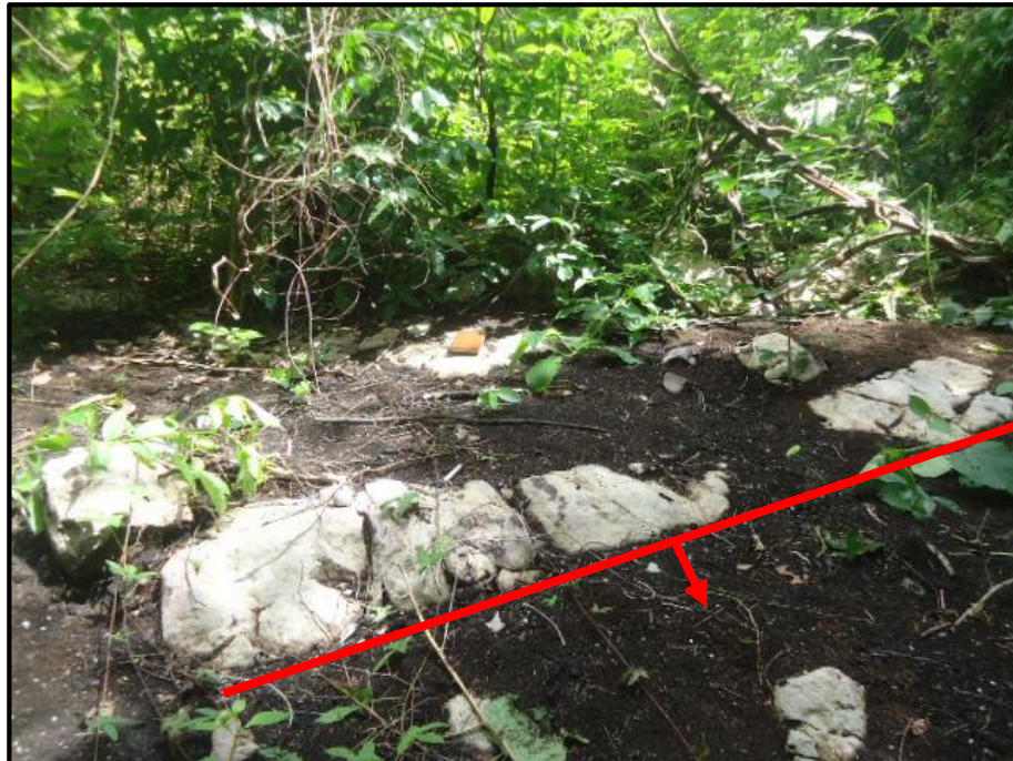
Figura 4.5. Afloramiento de calizas grises oscuras que meteorizan a color gris claro, con rumbo y buzamiento de N327^{\circ}25'SW . Coordenadas UTM (N1106547, E467762)
