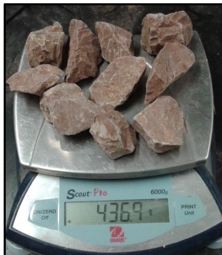
Figura 4.25. Procedimiento del Slake Durability Test a muestra de caliza de baja pureza Pica 5 - M231. A) Peso resultante del primer ciclo de humectación y secado. B) Peso resultante del segundo ciclo de humectación y secado.
