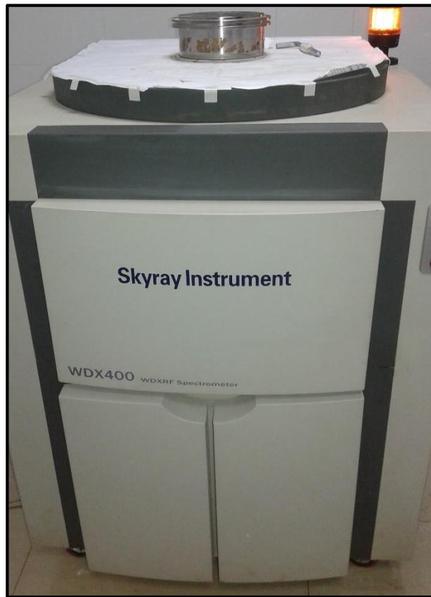
Figura 3.4. Imagen del equipo de Difracción de Rayos X Skyray WDX400, perteneciente al laboratorio de Control de Calidad de Cemento Cerro Azul.
