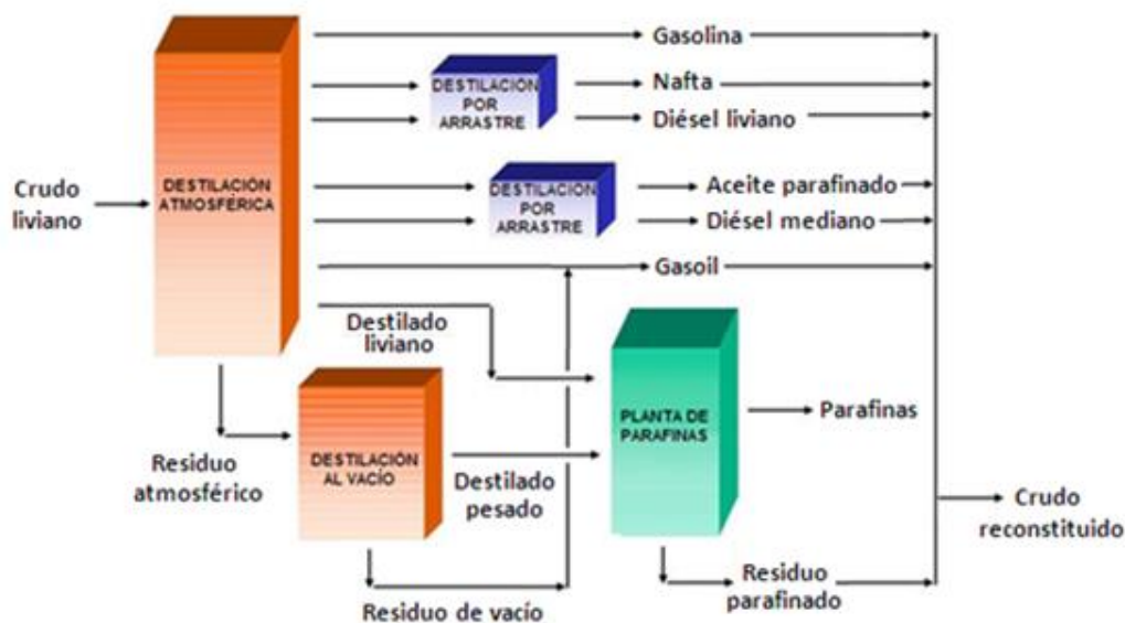
Figura N° 1. Diagrama de Bloques de la Refinería San Roque (Fuente propia).
