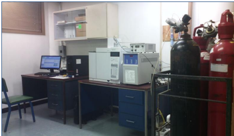
Figura N° 6. Cromatógrafo de gases, sistema de destilación simulada y análisis de azufre (CCPPQ).
