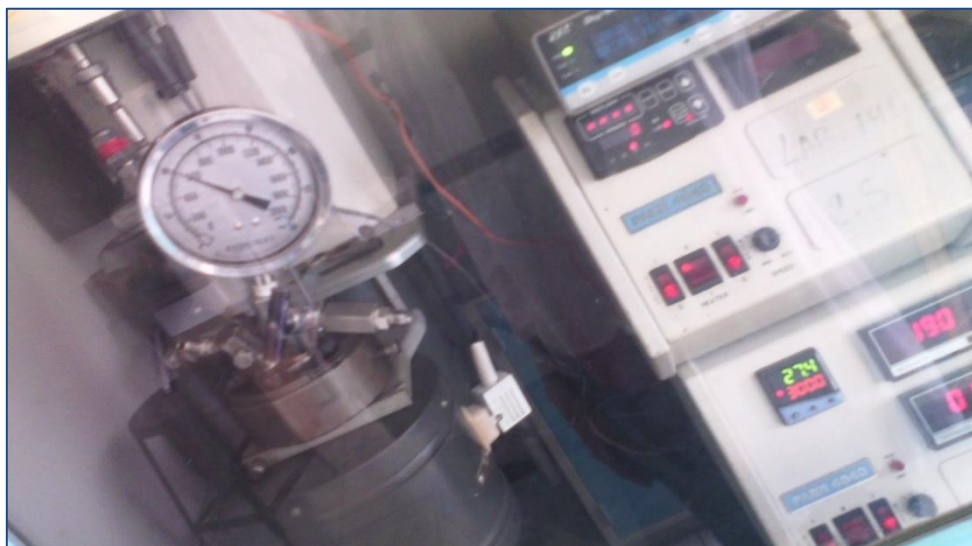
Figura N° 8. Montaje de reacción de HDT (Fuente propia).
