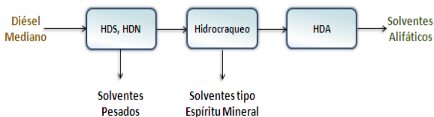
Figura N° 2. Etapas del proceso de HDT planteado para obtener solventes alifáticos empleando diésel mediano como materia prima (Meyers, 2004) (Lynch, 2008).
